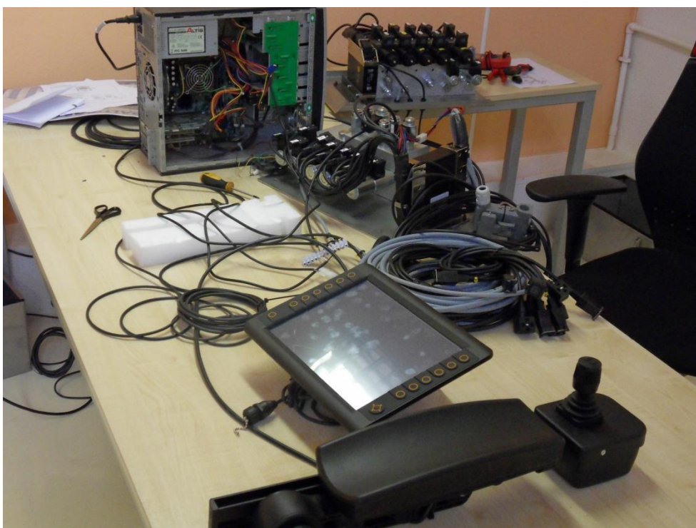
Sele 7.3. Juhtpult ühendatud hüdraulika komponentidega
