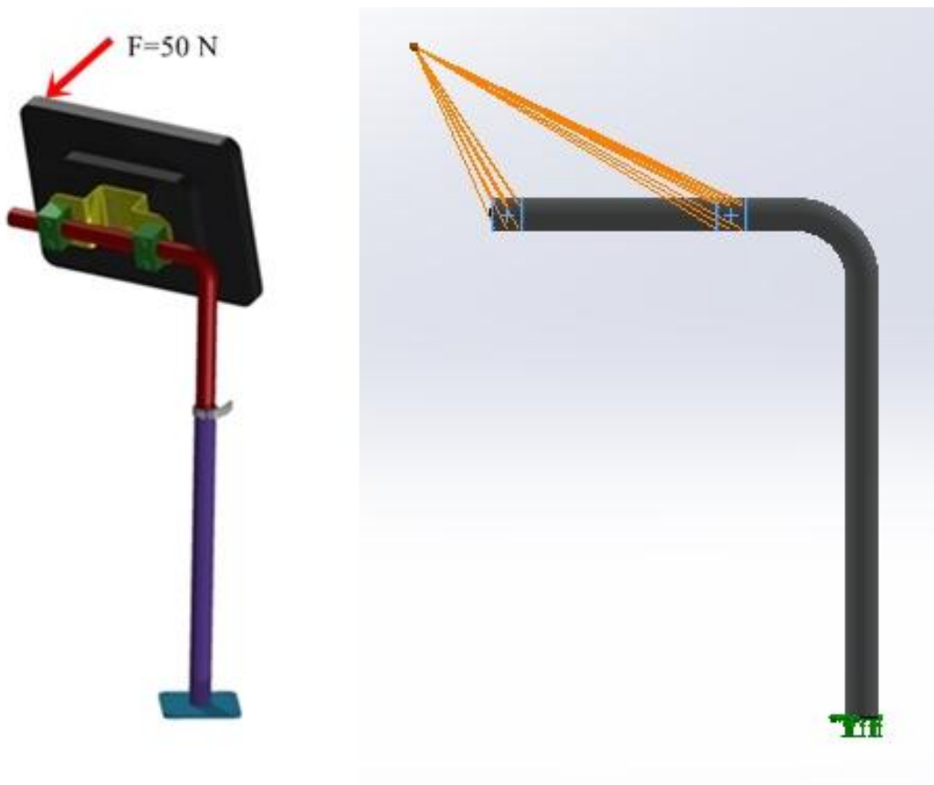
Sele 6.8. Koht, kuhu mõjub nupu vajutamisel jõud
