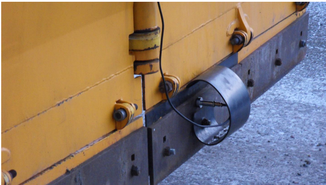
Sele 5.1. Esimene kasutuses olnud vibratsiooniandur
