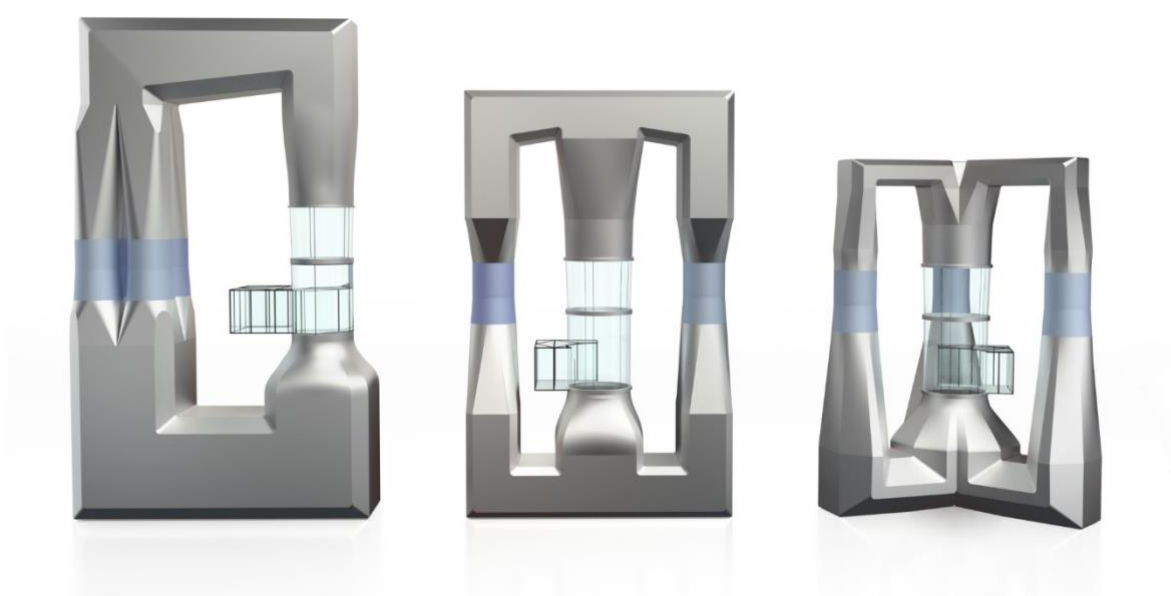
Joonis 1.6 Suletud süsteem vasakult: ühepoolne, kahepoolne ja kolmepoolne [11].
