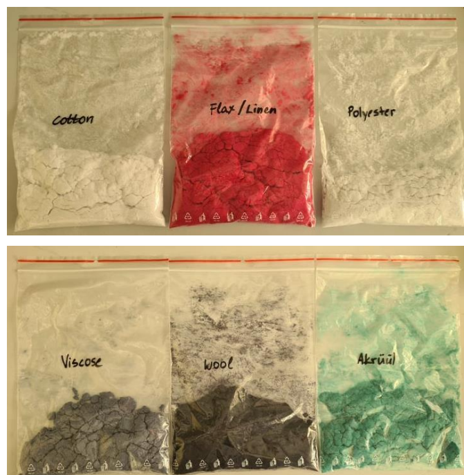
Joonis 7.13. Komposiitmaterjali tegemiseks valmis purustatud tekstiilmaterjal
