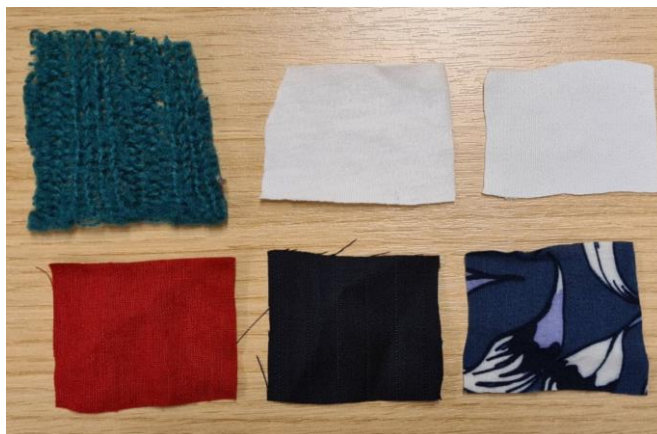
Joonis 7.1. Tekstiilmaterjalidest katsekehad. Ülevalt vasakult: akrüül, puuvill, polüester. Alt vasakult: lina, vill, viskoos.
