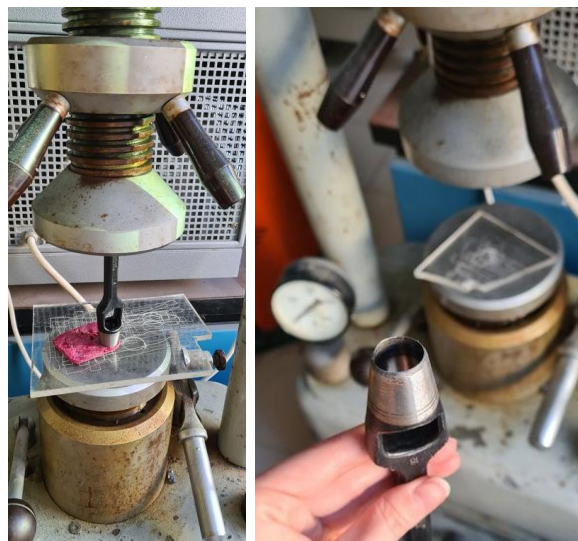
Joonis 6.10. Dezimalpresse DP 36 hüdrauliline press ning 18 mm diameetriga lõikevorm
