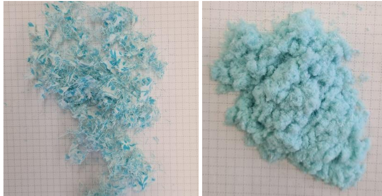
Joonis 7.12. Purustatud tekstiilmaterjalid: vasakul on ühekordselt purustatud materjal, mille puhul kasutati sõela avasuurusega 1 cm; paremal on kahekordselt purustatud materjal, mille teisel purustamisel kasutati väiksema avaga ehk 2 mm sõela.
