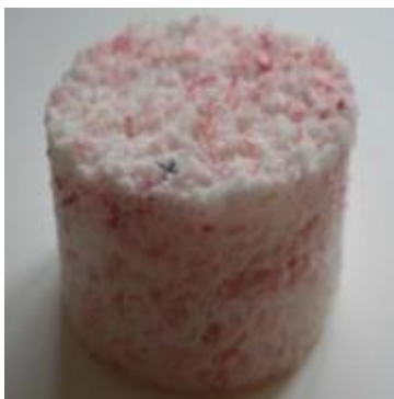
Joonis 4.1. Näidis heliisolatsioonmaterjalist, mis koosneb 70% polüuretaanvahust ja 30% tekstiilijätmetest (mis koosnevad sünteetilistest kiududest: 15% polüamiidi, 40% polüakrüüli, 45% modaali) [38]
