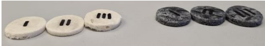
Joonis 7.25. Komposiitmaterjalist katsekehad: vasakul puuvillakiududega plastkomposiitmaterjal, paremal villakiududega plastkomposiitmaterjal
