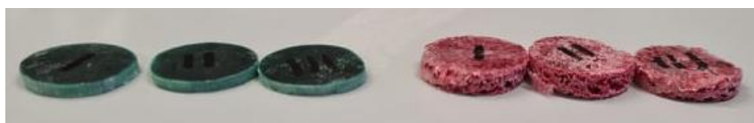
Joonis 7.23. Komposiitmaterjalist katsekehad: vasakul akrüülkiududega plastkomposiitmaterjal, paremal linakiududega plastkomposiitmaterjal
