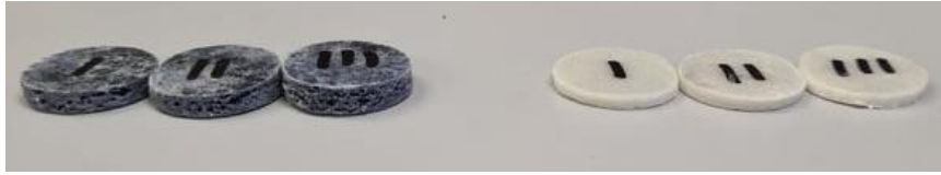
Joonis 7.24. Komposiitmaterjalist katsekehad: vasakul viskooskiududega plastkomposiitmaterjal, paremal polüesterkiududega plastkomposiitmaterjal
