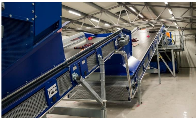
Joonis 2.6. Automaatne tekstiilmaterjalide transport konveierlindil [25]
