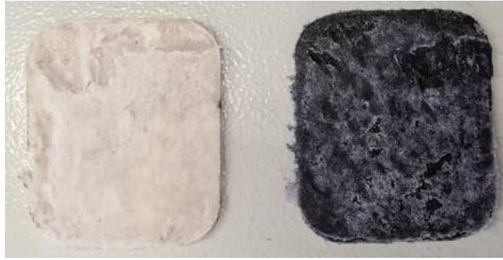
Joonis 7.15. Komposiitmaterjalist plaadid: valge on puuvillakiuga, must villakiuga
