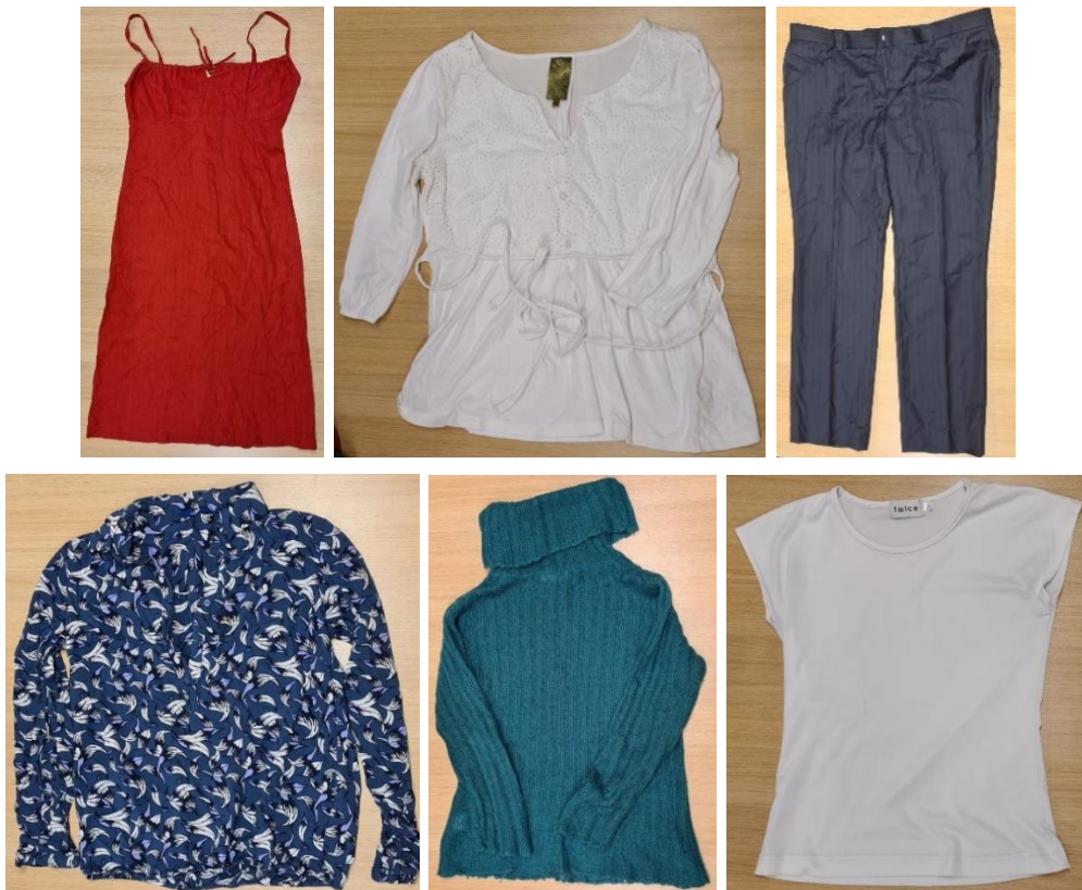
Joonis 6.1. Uuskasutuskeskusest toodud tekstiiltooted, mida kasutati plastkomposiitmaterjalide valmistamiseks. Rõivaste eeldatav kiuline koostis alustades ülemiselt realt vasakult: lina, puuvill, vill. Alumine rida vasakult: viskoos, akrüül, polüester.
