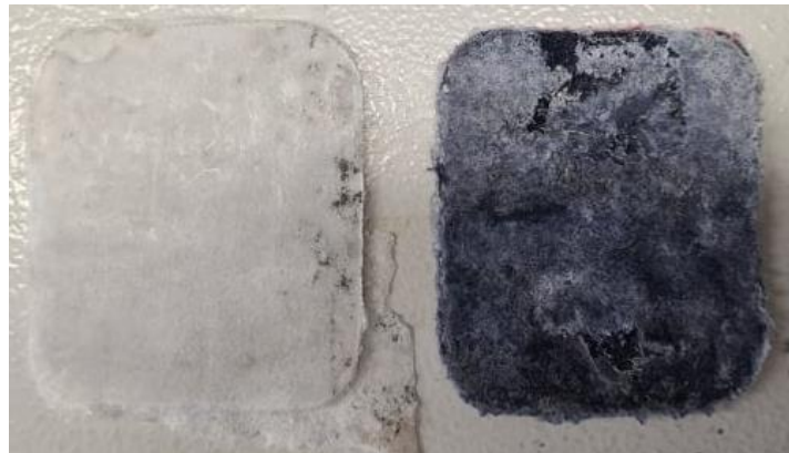
Joonis 7.16. Komposiitmaterjalist plaadid: valge on polüesterkiuga, tumesinine viskooskiuga
