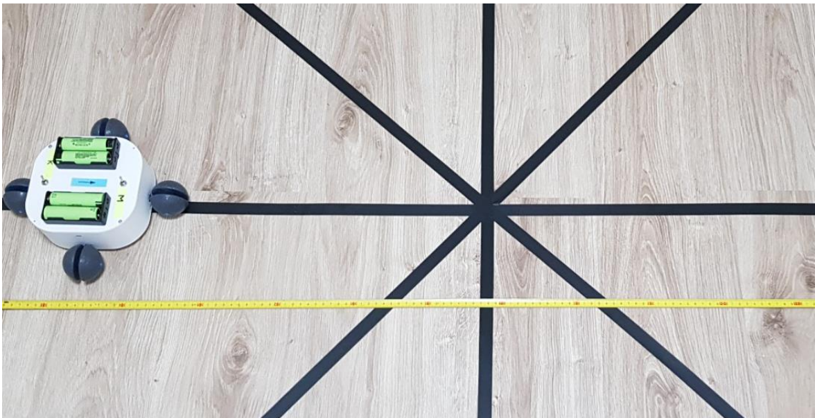
Joonis 3.3 Märgid liikumishälbe mõõtmiseks
