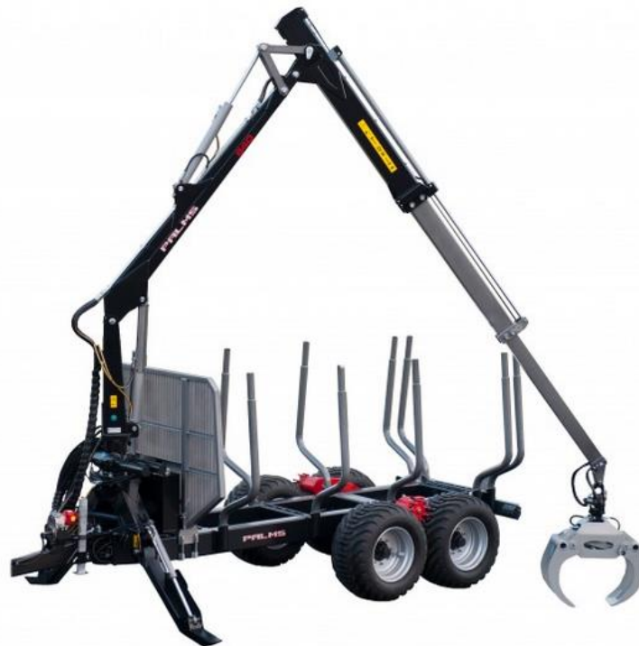
Sele1.1 Palms 15D metsaveohaagis kandevõimega 15 tonni [2]
