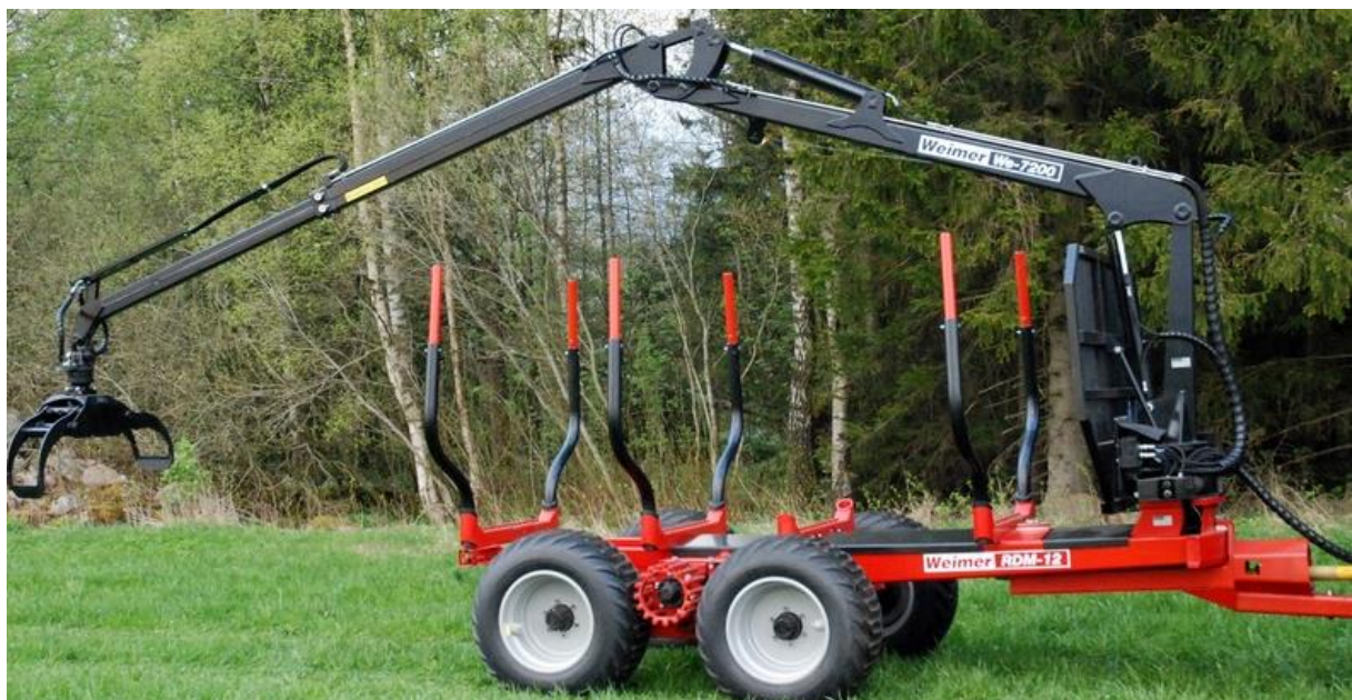
Sele 1.2 Weimer RDM 14 metsaveohaagis kandevõimega 14 tonni. [3]
