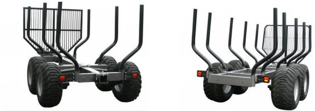
Sele 3.2.1 Haagiste tüübid: vasakul ühetalaline ja paremal kahetalaline [1]
