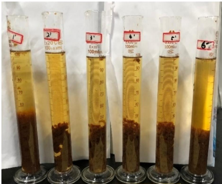
Joonis 12. Koaguleeritud prügila nõrgvesi pärast 30 minutulist settimist erinevate koagulandi dooside juures (Ren et al. , 2019).
