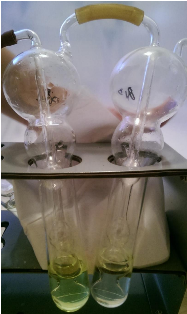
Joonis 5.4. Proovid vahetult pärast katse lõppu. Esimesena pumbatakse õhk läbi vasakpoolse absorberi. Lahuse kollakam värvus viitab kõrgemale formaldehüüdi sisaldusele
