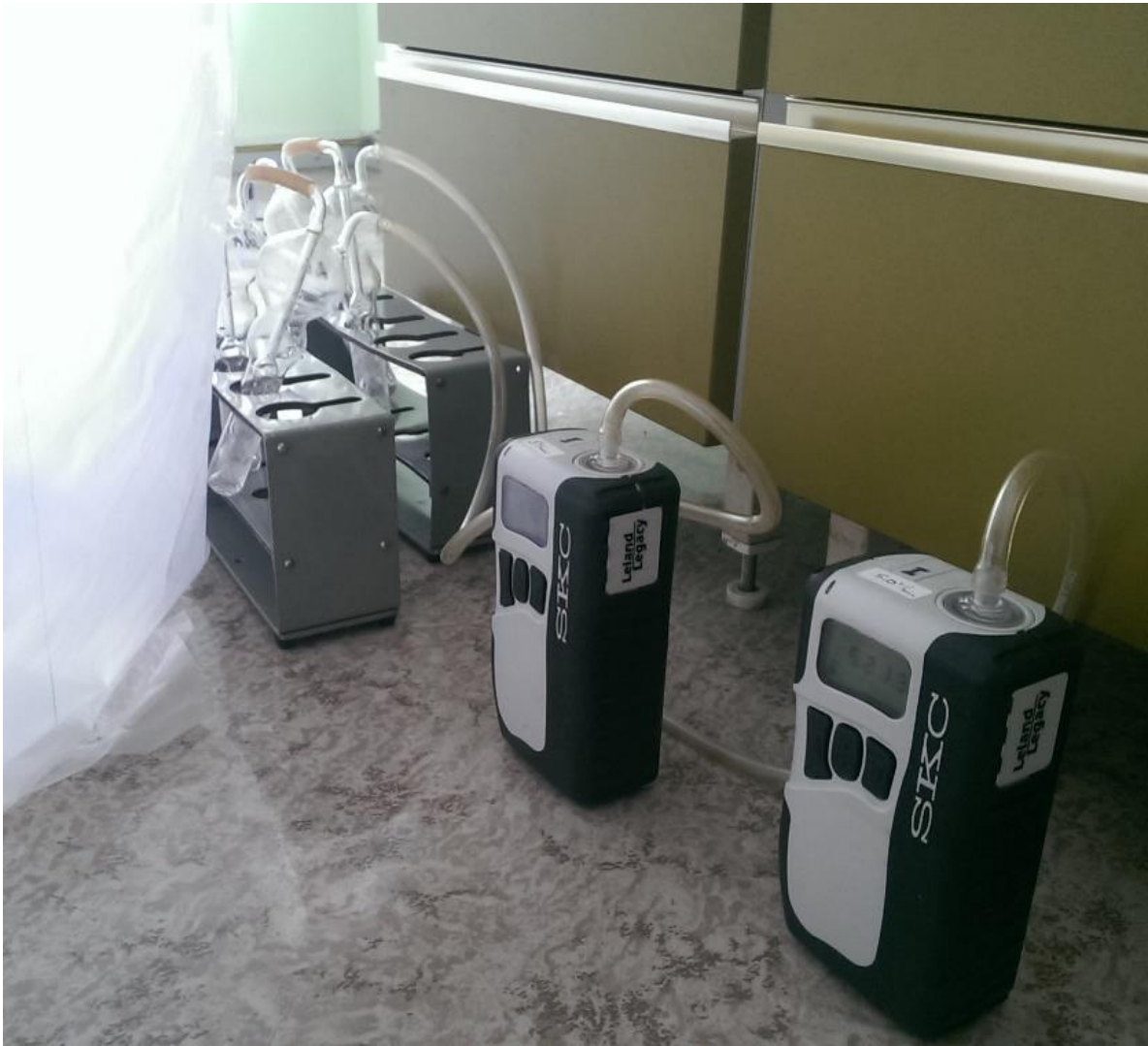
Joonis 5.5. Proovivõtmise protsess. Esiplaanil õhupumbad, ühendatud absorberitega
