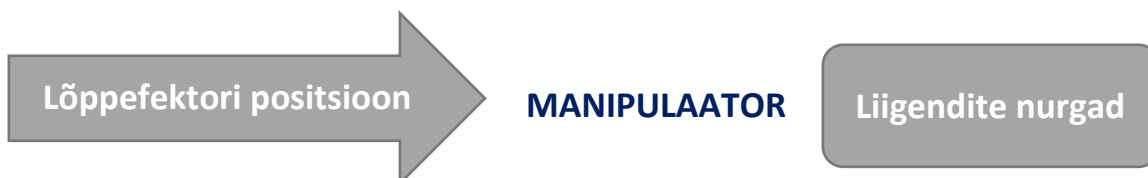
Joonis 2.1 Pöördkinemaatika ülesande skeem
