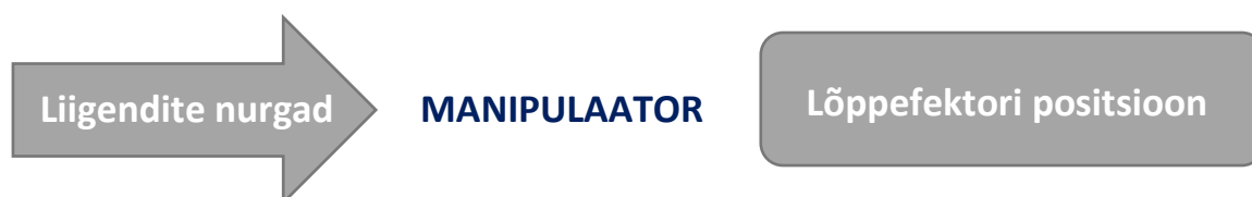
Joonis 2.2 Otsese kinemaatika ülesande skeem
