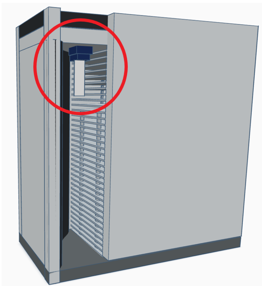
Joonis 11. Labaga anduri paigutus paremal pool akent asuva ventilatsiooniseadme näitel. Andur märgistatud punase ringiga
