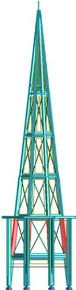
Joonis 3.4. Sarikate kõige kriitilisem piirkond survele koos paindega
