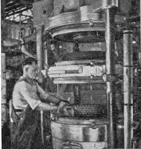
Joon. 1. Valuvorm hüdraulilise pressi all
