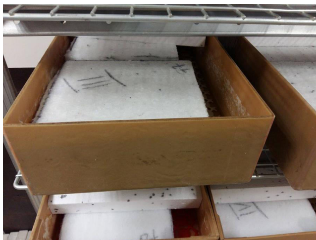
Joonis 9. Tallinna Tehnikaülikoolis tehtav osalise immersiooni test Toom Tekstiil AS materjalidega (autori foto)
