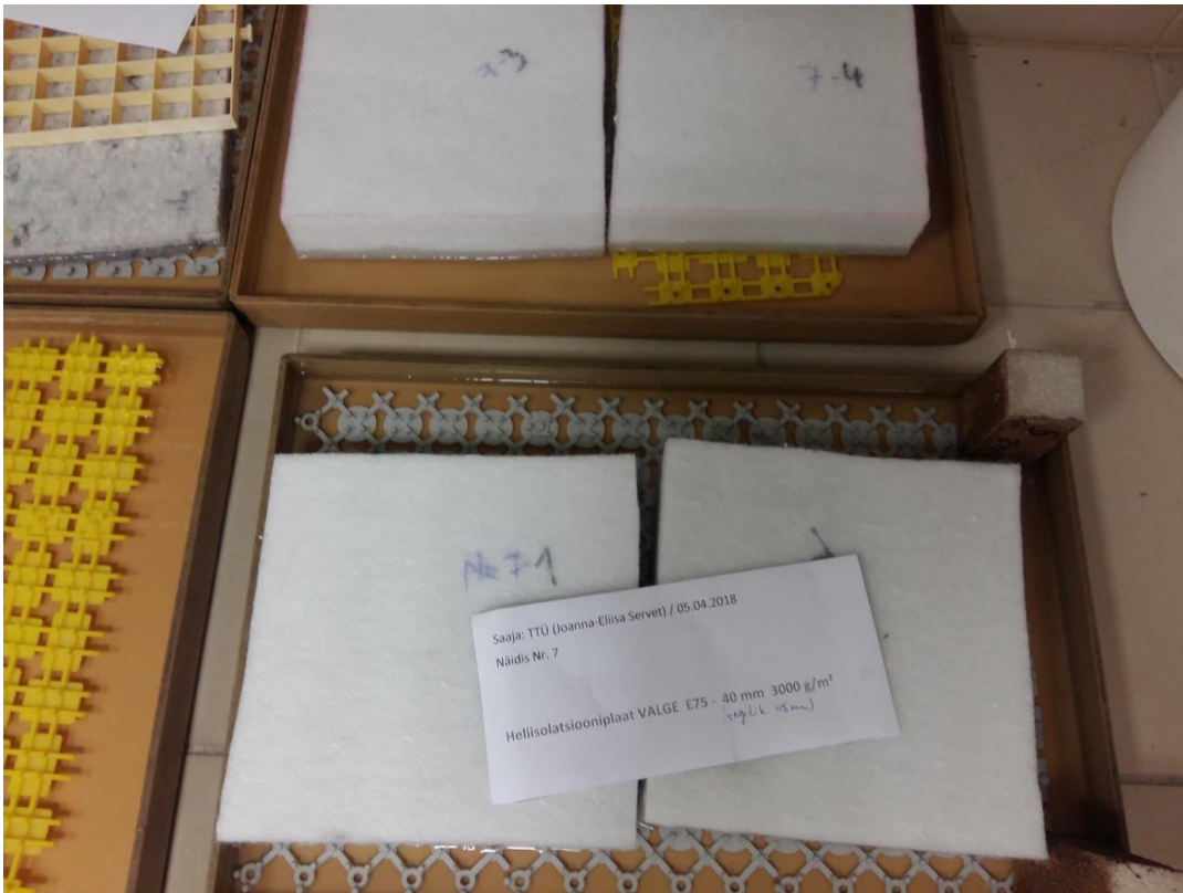
Joonis 31. Heliisolatsiooniplaat E75 katsetükid 10 millimeetris ves TTÜ ehitusmaterjalide teadus- ja katselaboratoriumi kliimalaboris
