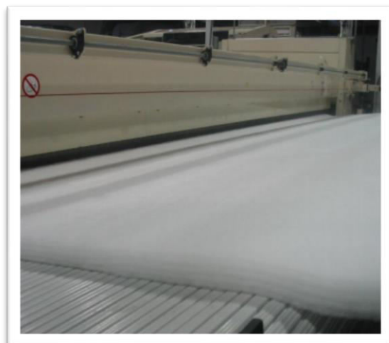
Joonis 26. Materjali tootmine- Aste I- segu ettevalmistus [2]
