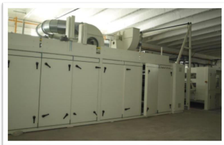
Joonis 30. Materjali tootmine- Aste III- Termiline töötlemine [2]
