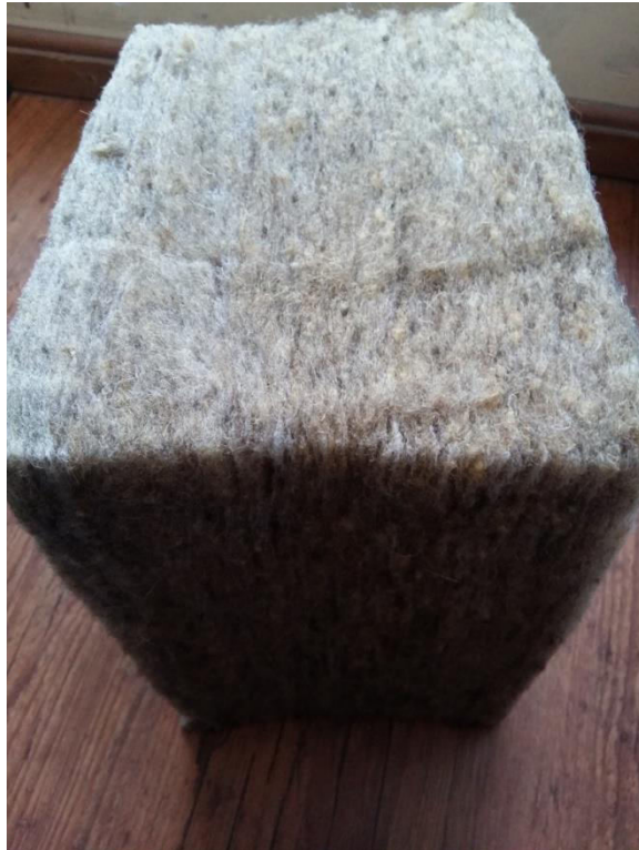
Joonis 2. Toom Tekstiil AS poolt toodetud villa soojusisolatsioonimaterjal (autori foto)
