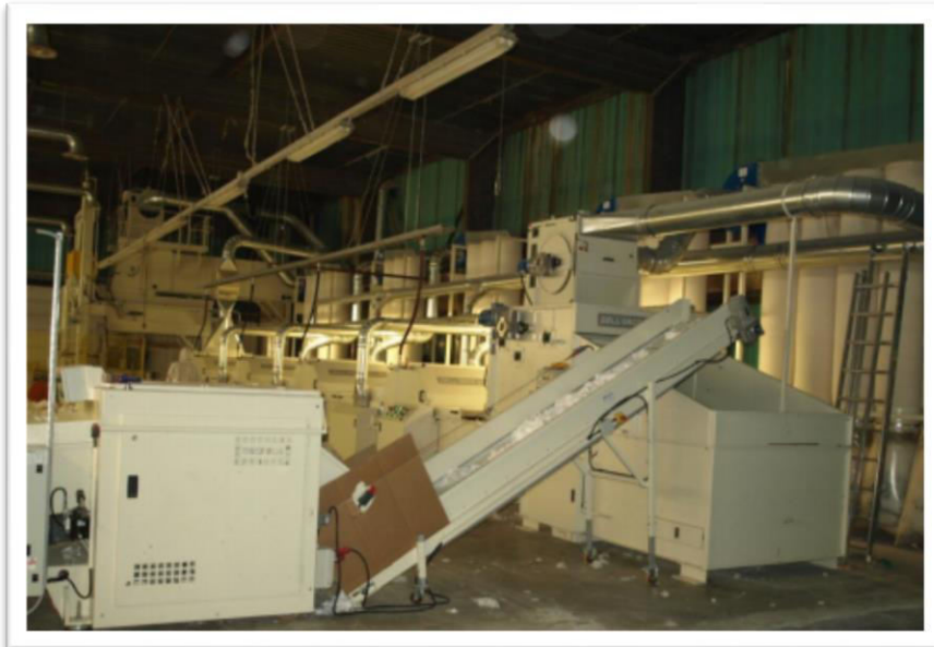
Joonis 21. Tekstiiljätmete ümbertöötlemine- I aste [2]
