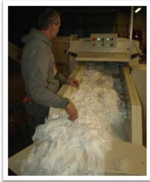
Joonis 21. Tekstiiljätmete ümbertöötlemine- I aste [2]
