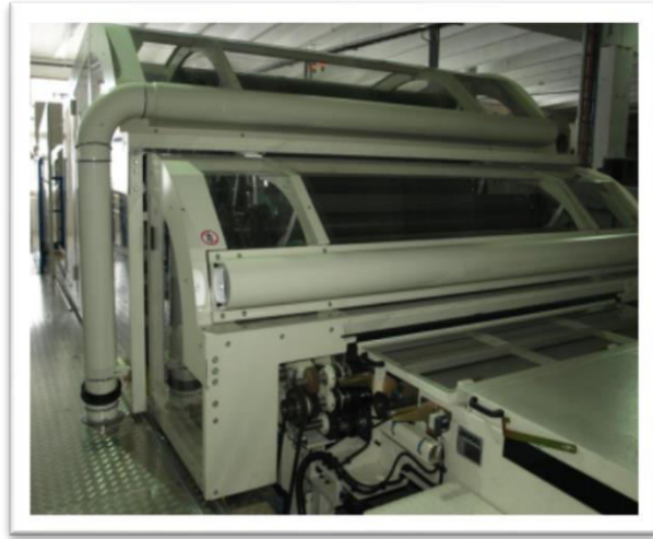
Joonis 28. Materjali tootmine- Aste II- Kraasimine [2]
