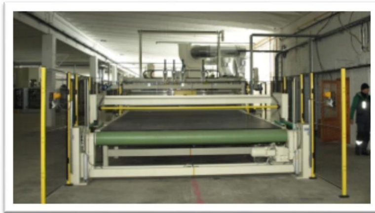
Joonis 29. Materjali tootmine- Aste III- Termiline töötlemine [2]
