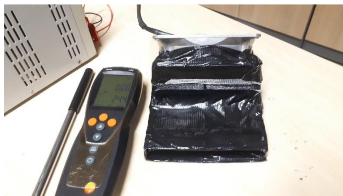
Joonis 6-2. Soojusvahetit läbiva õhu vooluhulga määramise katse
