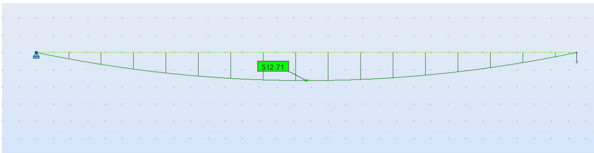
Joonis 4.11. Liimpuittala paindemomendi epüür (kNm)
