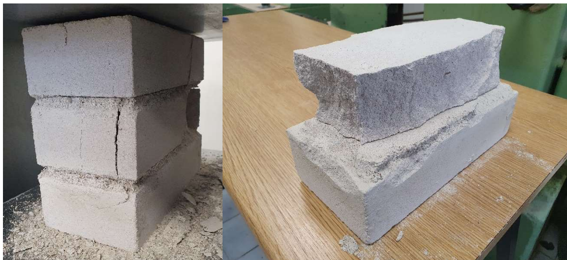
Joonis 8.1 Koormuse all purunenud müüritise katsekeha vahetult pärast purunemist ja pärast ülemise tellise ja lahtiste tükkide eemaldamist
