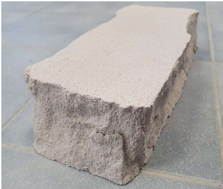
Joonis 5.2 Silikaattellis pärast koormamisel purunemist
