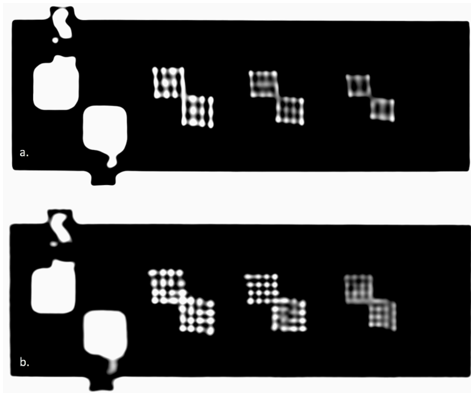
Joonis 28. Kõrge kontrastsusega lahutusvõime testi elemendid katseseeriast nr. 13. a.) Originaalparameetritega katseseeria (SE, T1, TE=14 ms, TR=500 ms); b.) OFK PE 0,5 + FE (SE, T1, TE=20 ms, TR=500 ms); Katseseade C.
