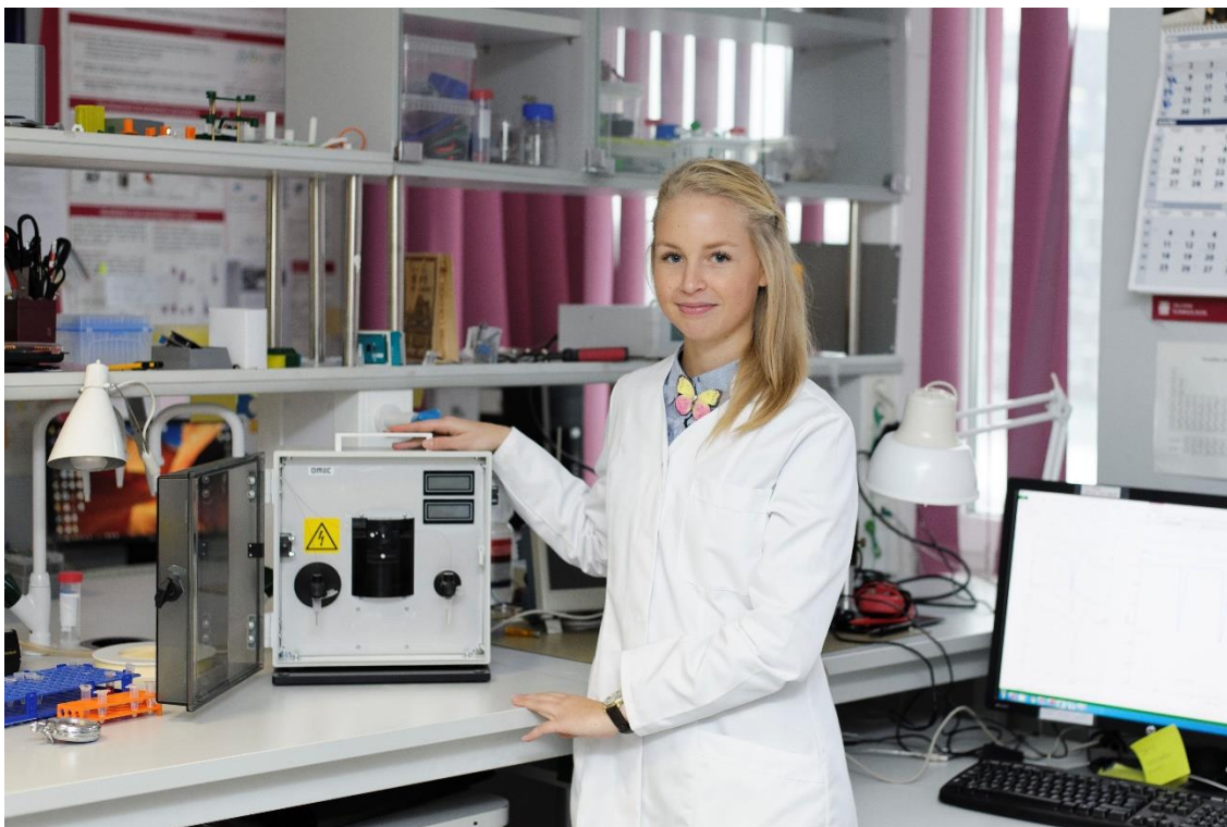
Joonis 12. CE-FLU2 kapillaarelektroforeesi seade. Model - Kati Muldma, Fotograaf - Lauri Mölder. Publitseeritakse TalTech, KBI, teadurite Jelena Gorbatsova ja Jekaterina Mazina-Šinkar loaga.
