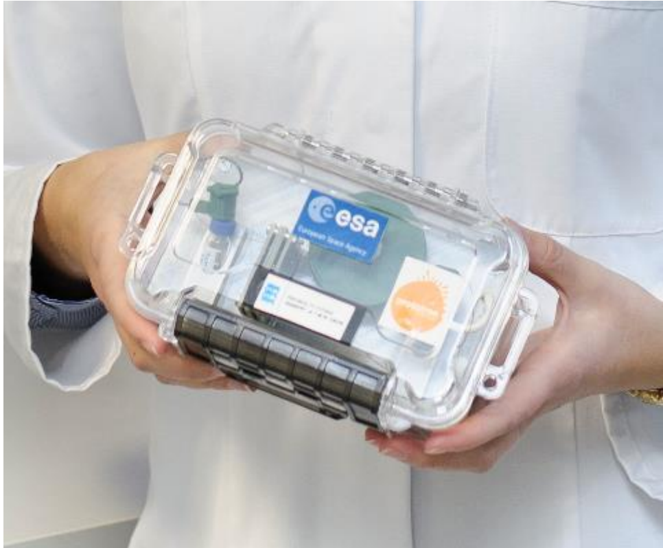
Joonis 15. CE-C4D kapillaarelektroforeesi seade. Model - Kati Muldma, Fotograaf - Lauri Mölder. Publitseeritakse TalTech, KBI, teaduri Jelena Gorbatsova loaga.
