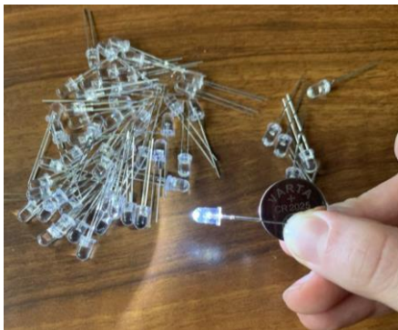
Pilt 2.4-1 LEDide kontrollimine patareiga
