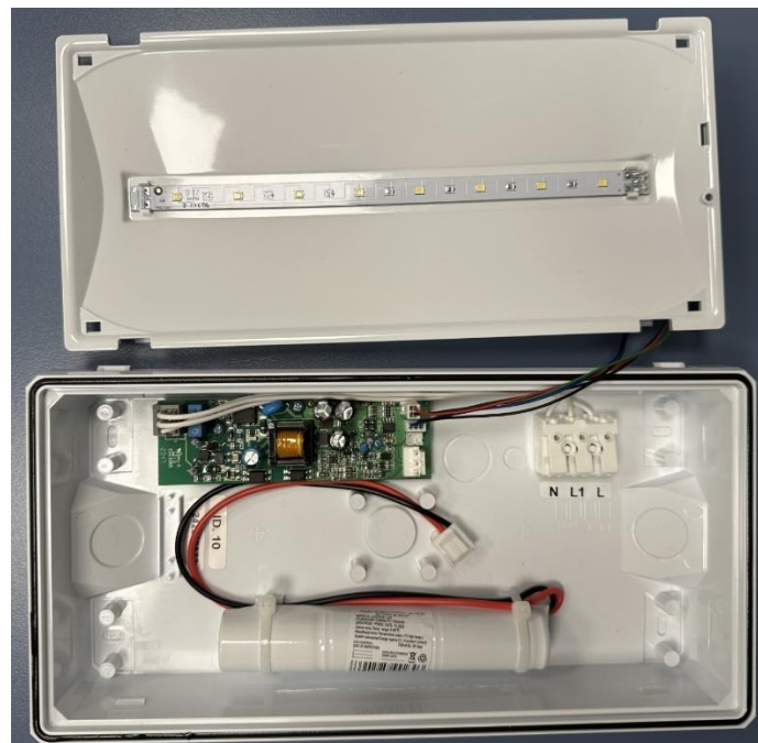
Joonis 2.1 Tootja AWEX endatoiteline inverteri ja akuga hädavalgusti Exit M
