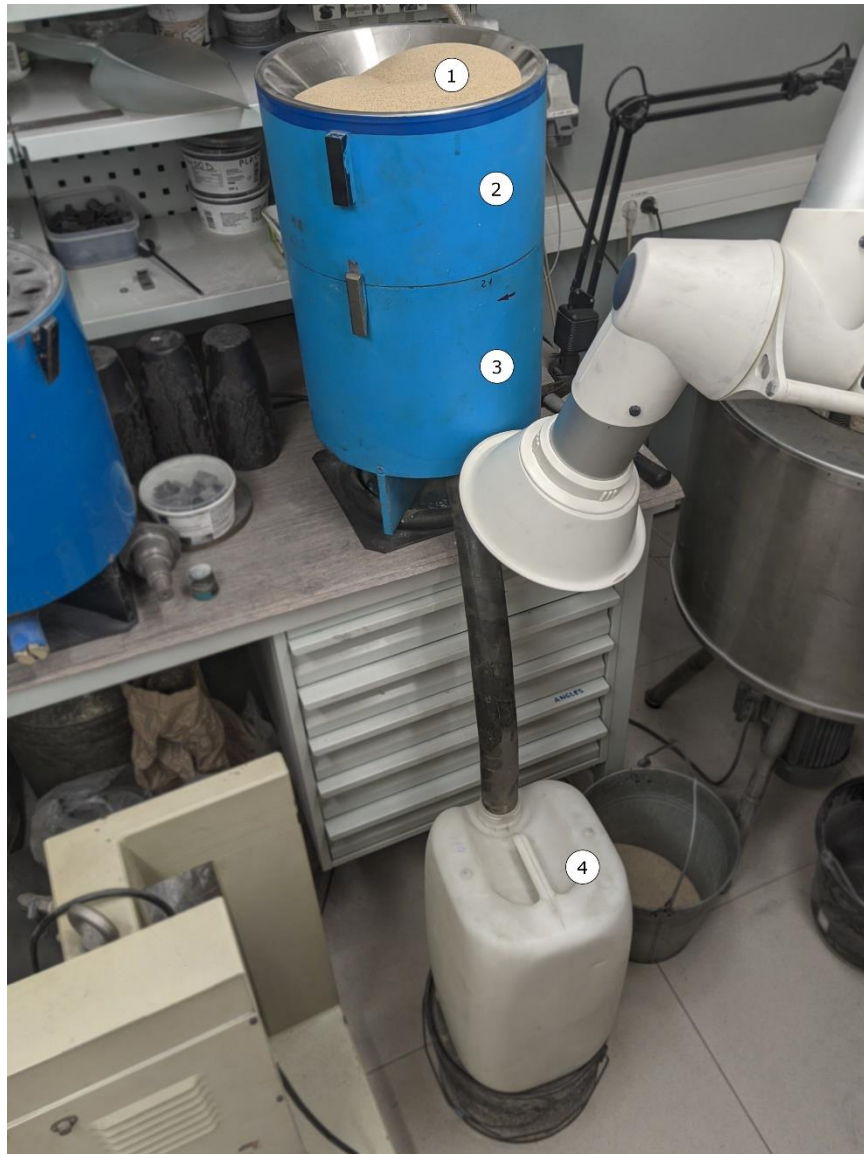
Joonis 2.15. Tsentrifugaalkiirendi CAK-5: 1) abrasiiv, 2) lehter koos korpusega, 3) korpus, 4) kasutatud abrasiivi kogumiskoht [Autori foto]
