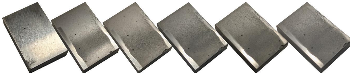
Joonis 3.5. S108 katsekeha pind (vasakult paremale) enne kulutamist ja pärast järjestikuseid kulutamiskatseid (tegemist on keskmisest vähem kulunud materjaliga) [Autori foto]
