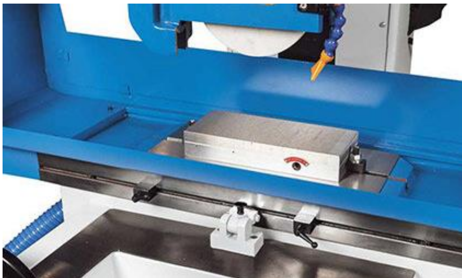
Joonis 4.2. Knuth FSM 480 lihvimismasina magnetiline kinnitusplaat [18]
