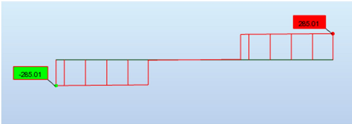
Joonis B.4. Peatala maksimaalne põikjõu eptüür 3.ULS olukorras (kN) (ARSAP 2017).
