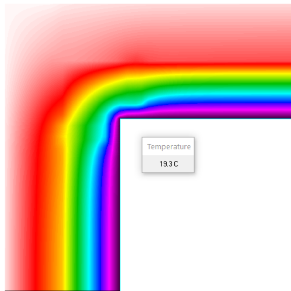
Joonis 4.6 Välisseina sisnuruga temperatuurierinevused THERM 7.7
