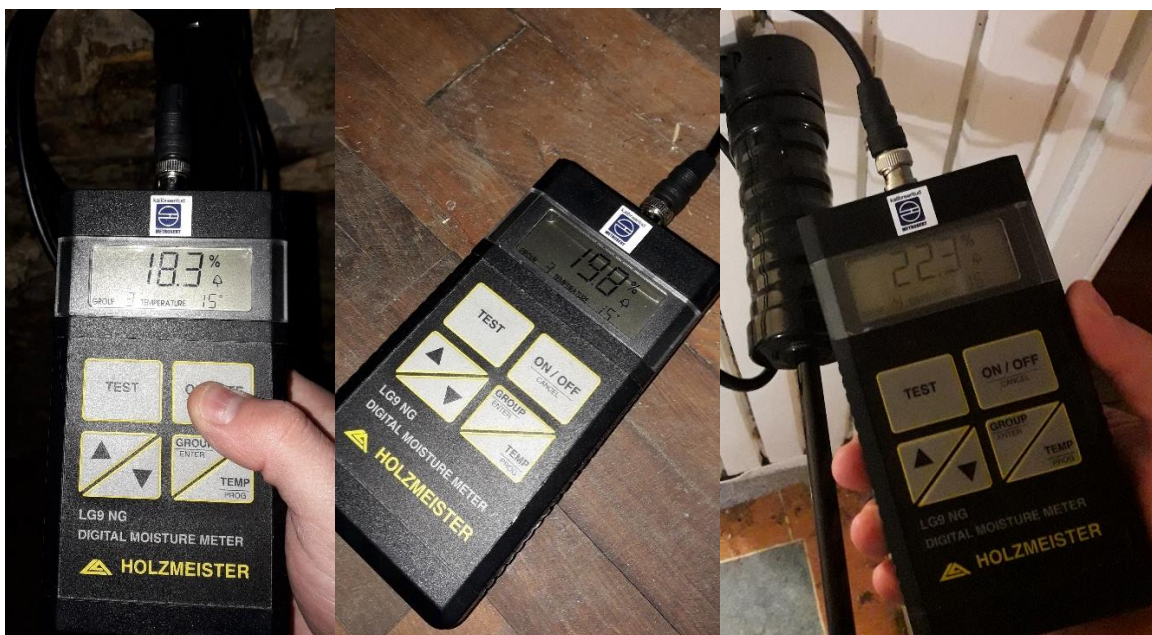
Joonis 2.42 Hoone lõunapoolse osa seintes mõõdetud niiskus
