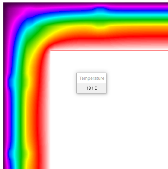
Joonis 4.2 Välisseina välisnurga temperatuurierinevused THERM 7.7
