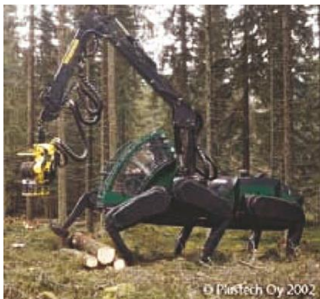
Joonis 1.2 Plustech poolt prototüübitud jalgedel kõndiv harvester [6]
