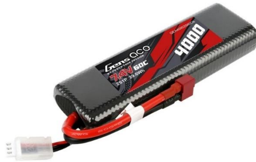
Joonis 3.3 Gens ace 4000mAh 2S 7,4V 60C LiPo aku [24]
