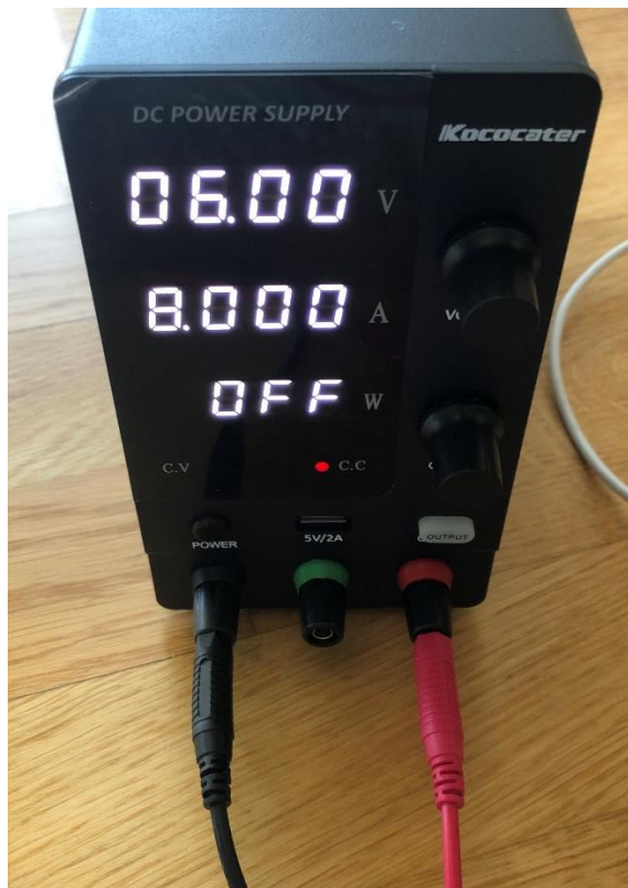
Joonis 5.1 Katsetustel kasutatav reguleeritav toiteplokk
