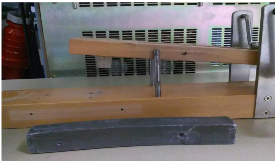
Joonis 11 Stoneridge Electronics AS testsüsteemi testotsiku kinnitus
