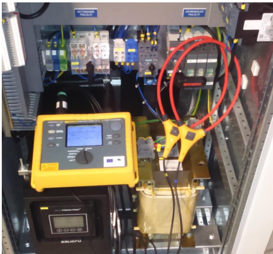
Joonis 7.17 Omatarbe võimsuse kadude mõõtmine
