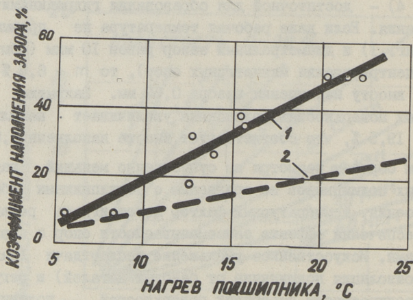
Фиг. 5. Экспериментальная (1) и теоретическая (2) зависимости наполнения зазора маслом при нагреве подшипника (размеры втулки: d = 2 мм, D = 6 мм, l = 5 мм; пористость \Pi = 28\% ; материал втулки: ПЖ1К; диаметральный зазор \Delta = 25-50 мкм).
