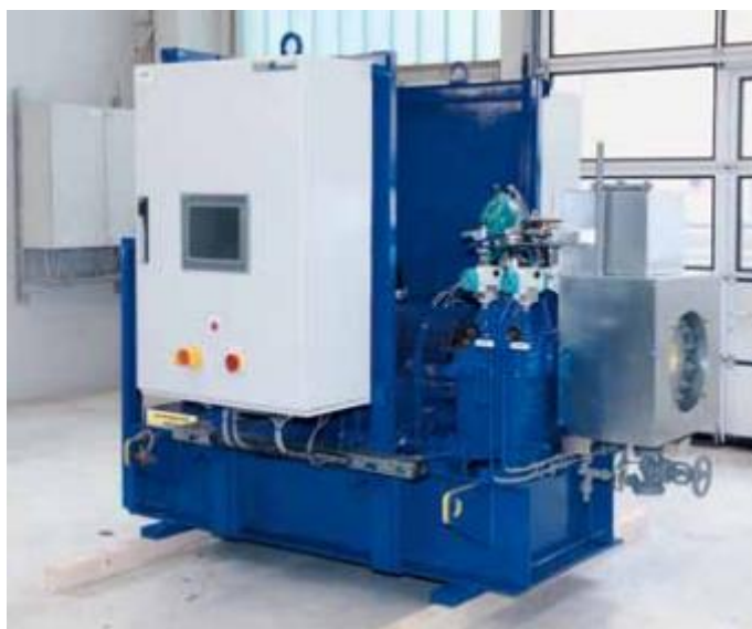
Joonis 3.8. Siemensi SST tüüpi koostootmisseade
