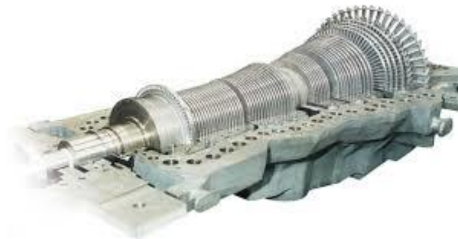
Joonis 3.10. General Electricu auruturbiini läiblõige
