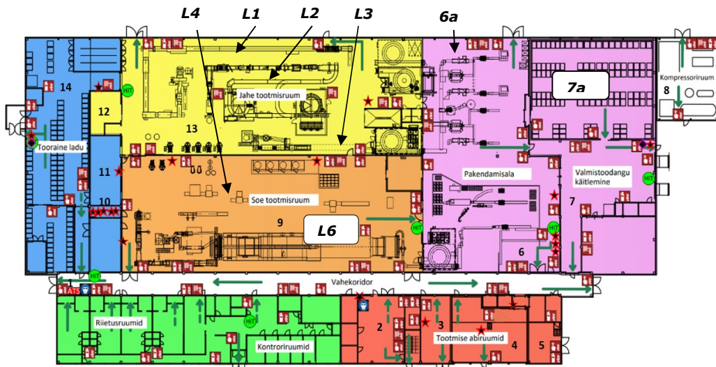
Skeem 2.2. Tehase plaan (I korrus) [1]. Olulisemad viited: 2) Quanti töökoda; 6a) pakke-(robot-)liinid; 7a) valmistoodangu külmladu; 8) ammoniaagitehas; 9) soe tootmisruum, liin L4 (SAU-100-400) ja liin L6 (SAU-100-600); 10) hügieeniruum; 11) testpagar; 12) tooraine ettevalmistus; 13) jahe tootmisruum, liinid L1 (SAU-100-100), L2 (SAU-100-200), L3 (SAU-100-300); 14) tooraineladu.
