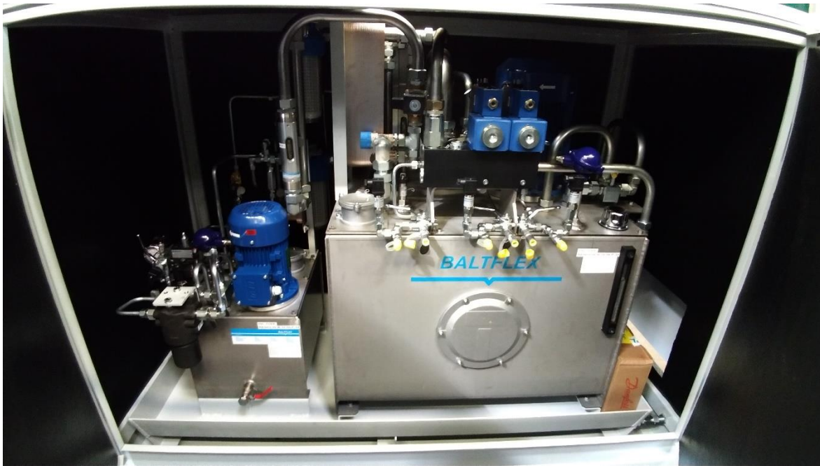
Sele 4.8 Kõrvuti paigutatud hüdrojaamad korpuses.
