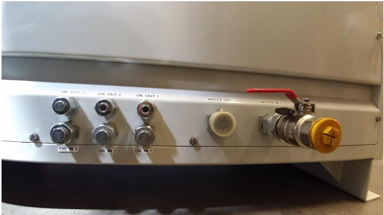
Sele 7.3 Väljundid ja sisendid maja tagumise seina alumises osas.
