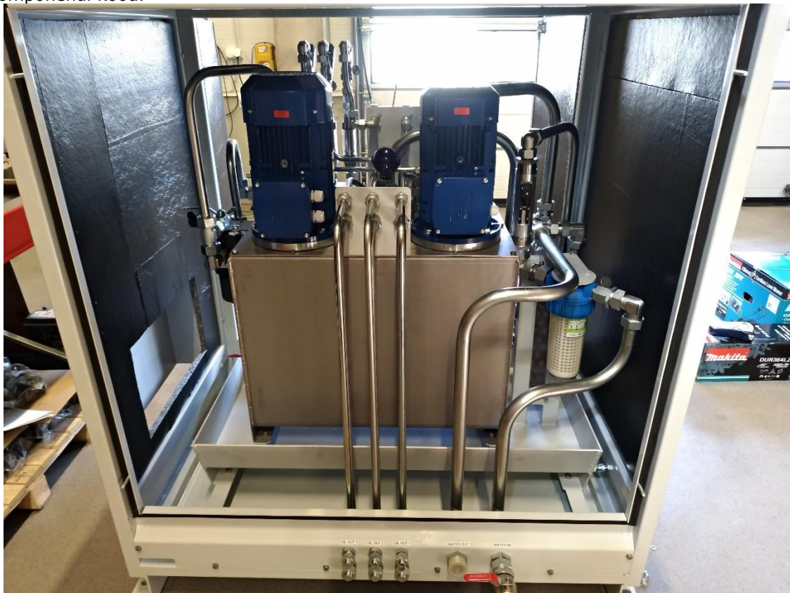
Sele 5.7 Hüdrojaama tagantvaade. Kõik ühendused on viidud korpuse tagumise seina alumisele osale.
