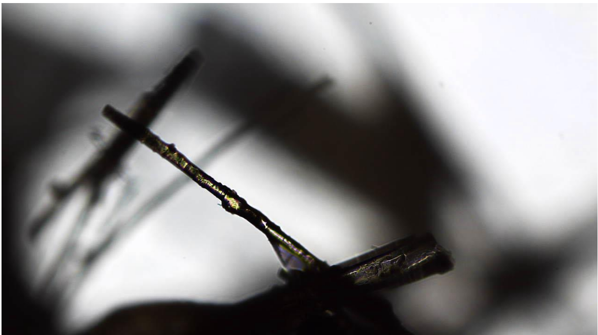
Joonis 4.6 Mineraalvilla kiud suurenduse all, tegemist klaasvillaga (Foto: Jane Raamets, aprill 2022)
