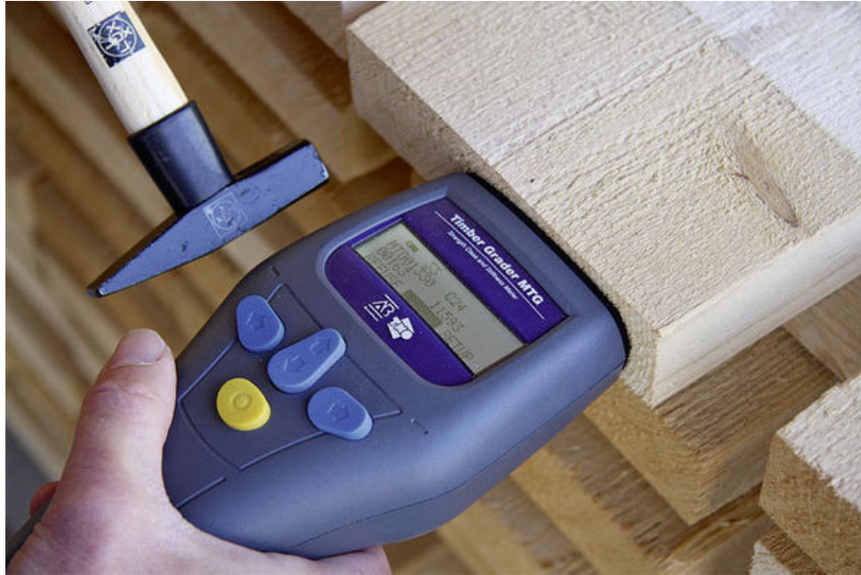
Joonis 4 Helilaine tekitamine haamriga [16]
