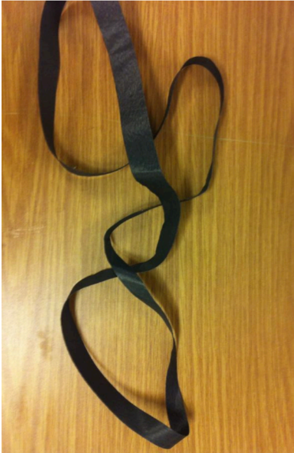
Joonis 14. 20% põlevkivituha kontsentratsiooniga riba, mida ei õnnestunud kileks puhuda.
