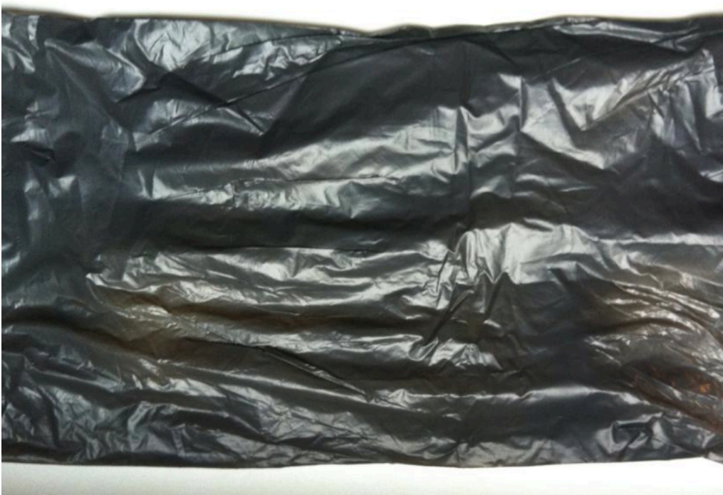
Joonis 13. 15% põlevkivituha kontsentratsiooniga kile peale materjali kuivatamist ja niiskuse absorberi lisamist.
