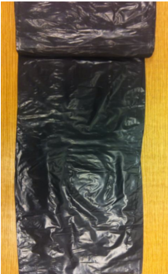
Joonis 11. 5% põlevkivituha kontsentratsiooniga kile.
