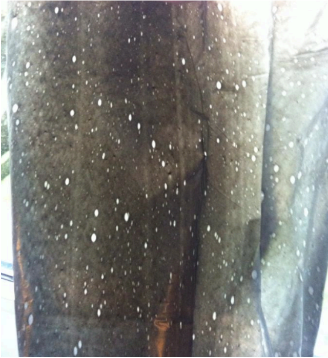
Joonis 12. 15% põlevkivituha kontsentratsiooniga kile enne materjali kuivatamist ja niiskuse absorberi lisamist.
