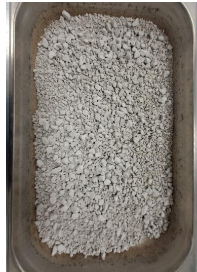
Joonis 15. Sama LA proov pärast trumlit ja sõelumist läbi 1,6 mm sõela.
