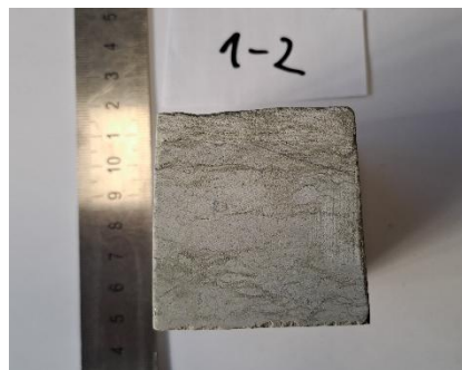
Joonis 29. Survetugevus katsekeha 1-2.
