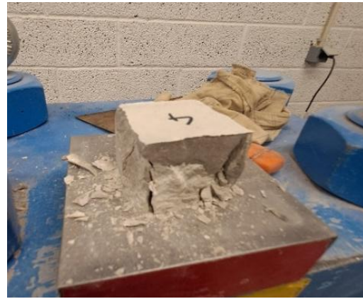
Joonis 8. Katsekeha pärast survetugevuse katset.
