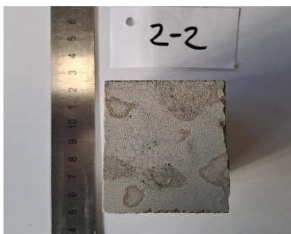
Joonis 32. Survetugevus katsekeha 2-2.
