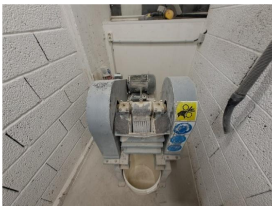
Joonis 9. Lõugpurusti Teede Tehnokeskuse laboris.
