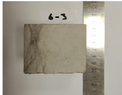
Joonis 45. Survetugevus katsekeha 6-3.
