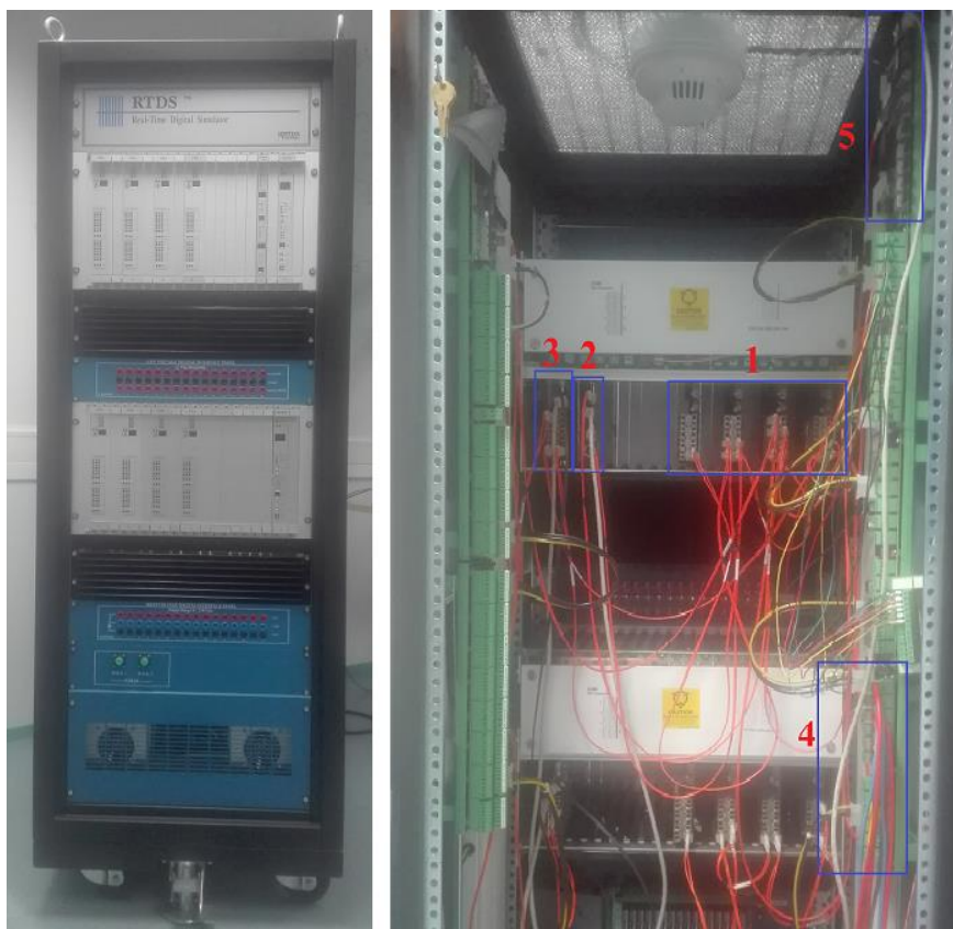
Joonis 3.2. RTDS eest- ja tagantvaates (eestvaade vasakul, tagantvaade paremal)
