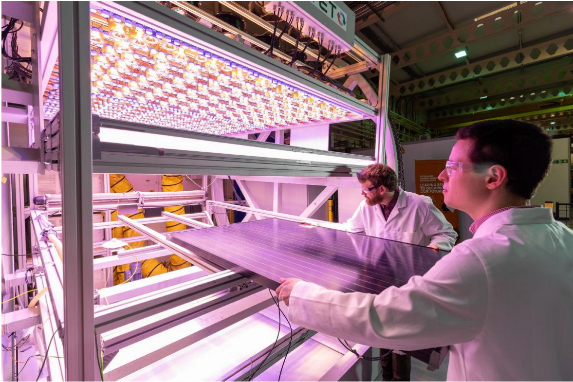
Joonis 3.3 Warwick Ülikooli päikeseenergialabori päikesesimulaator [43]
