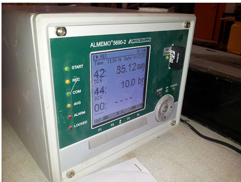
Joonis 3.10. Andmesalvestussüsteem ALMEMO 5690-2 AHLBORN.
