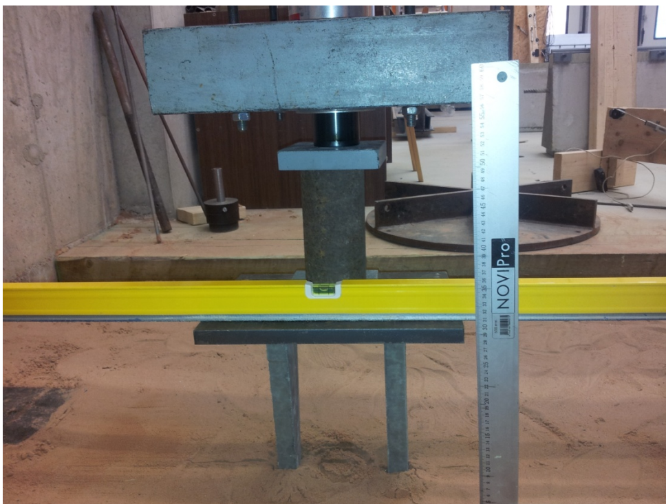
Joonis 6. Vaialuse rihtimine vesiloodiga.
