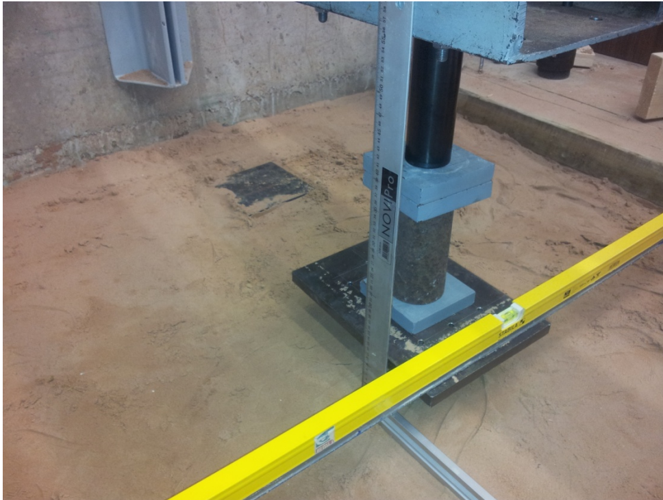
Joonis 5. Vaialuse rihtimine vesiloodiga.
