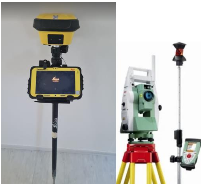
Joonis 5.1 Vasakul kujutatud GPS rover ja paremal elektriline tahhümeeter
