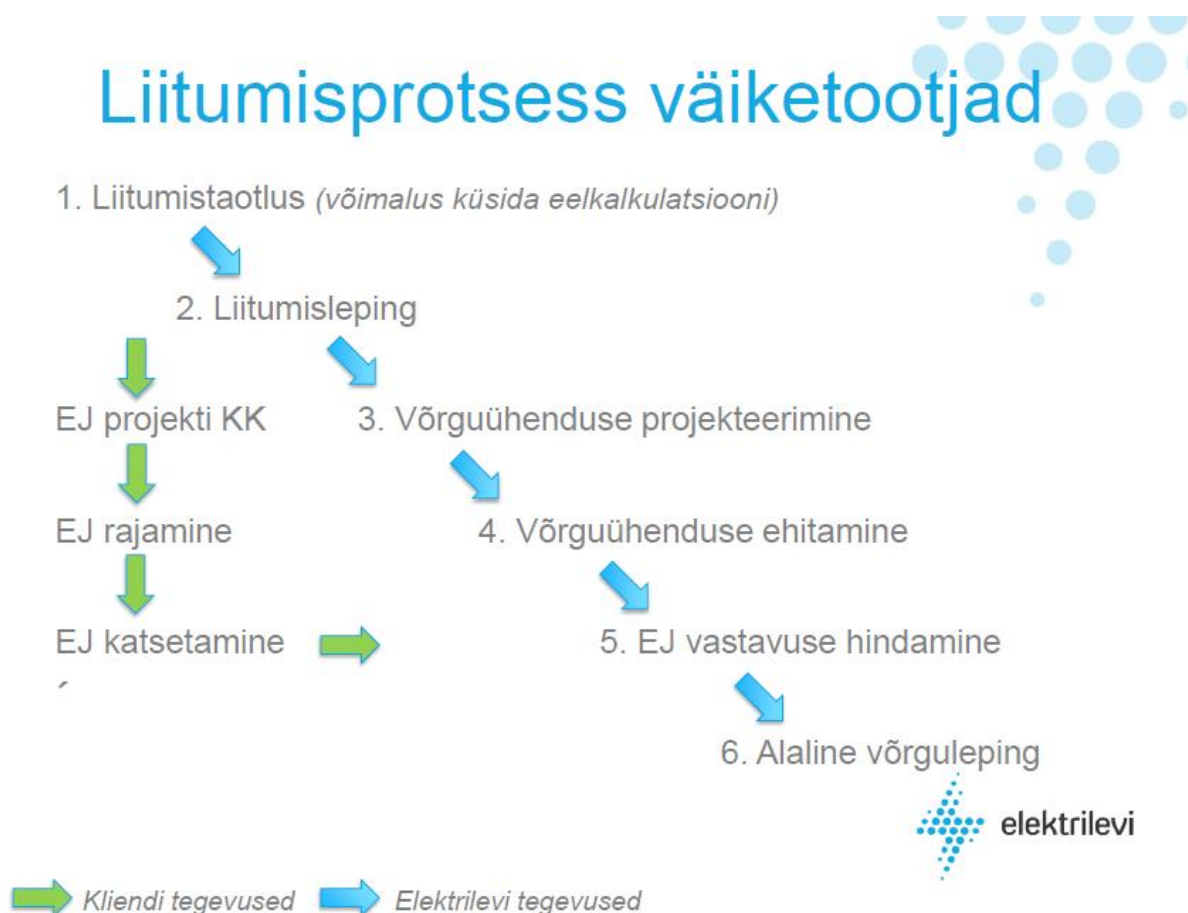
Joonis 3.1 – Mikro-, pisi- ja väiketootja liitumisprotsess Elektrilevi OÜ's [34]
