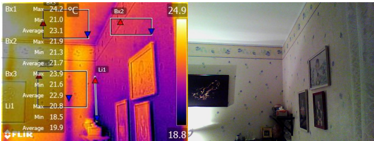
Joonis 4.12b. Külmasild välisseinte ja lae liitumisel jaanuaris. Vasakul termopilt ja paremal foto samast kohast.
