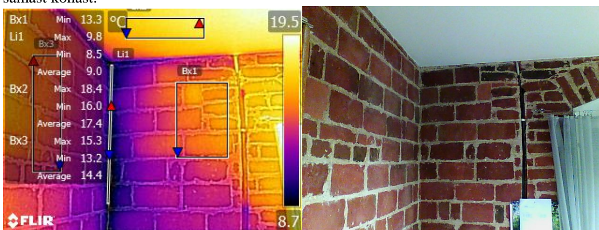
Joonis 4.5b. Külmasild välisseina liitekohas jaanuaris. Vasakul termopilt ja paremal foto samast kohast.
