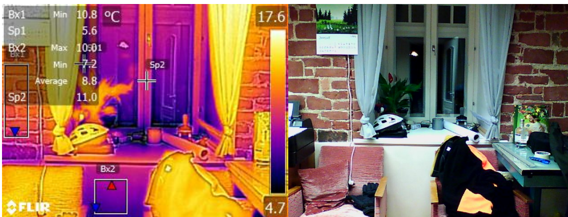
Joonis 4.3b. Külmasild akna ja seina liitekohas jaanuaris. Vasakul termopilt ja paremal foto samast kohast.
