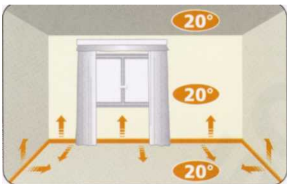
Joonis 1.1. Soojuse jaotumine ruumis põrandaliist küttega.[15]
