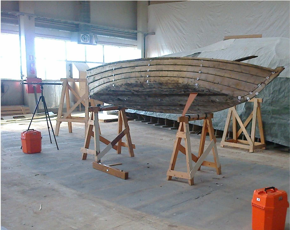
Joonis 9: Mõõdetav objekt ja koordinaatsüsteemi mõõtlatt (vasakul)
