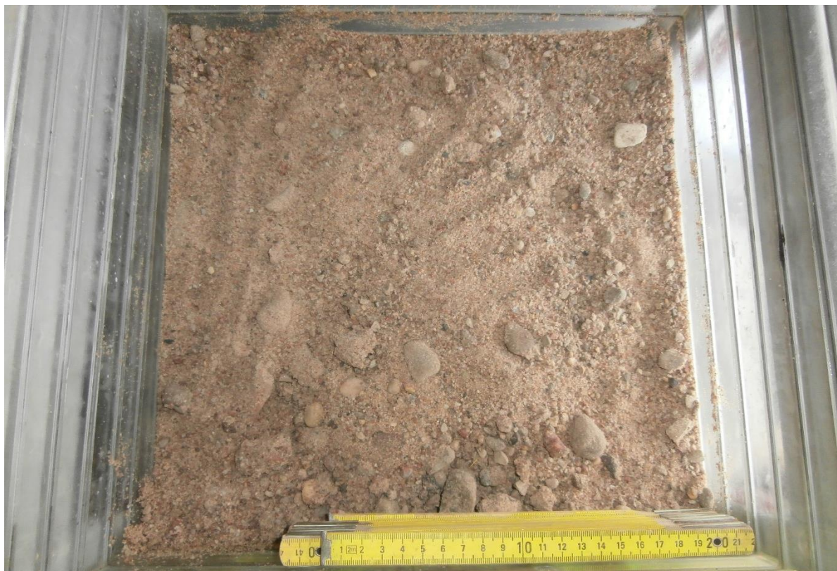
Joonis 22 Kruusa-liiva segu märgsepareerimise seadmes enne katse teostamist
