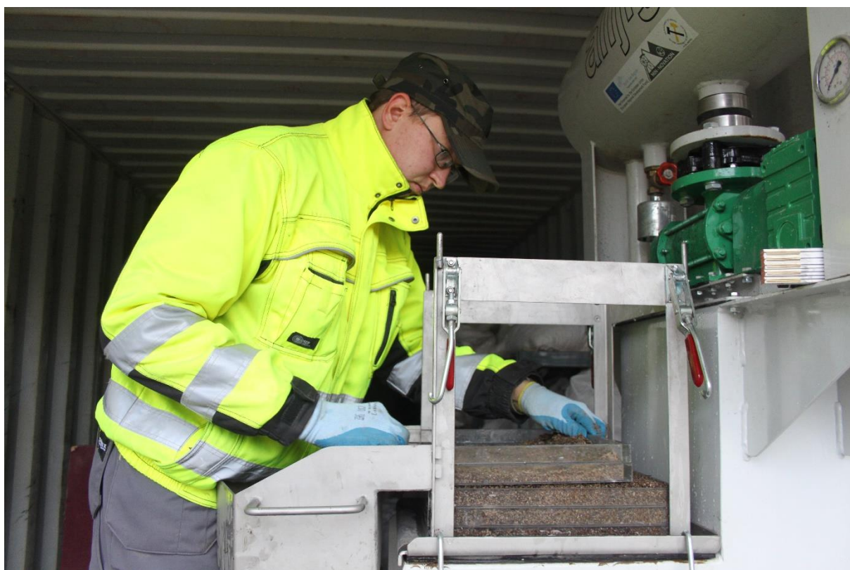
Joonis 5 Erinevate kihtide kogumine märgsepariirimsseadmest (foto: Mäeinstituut)
