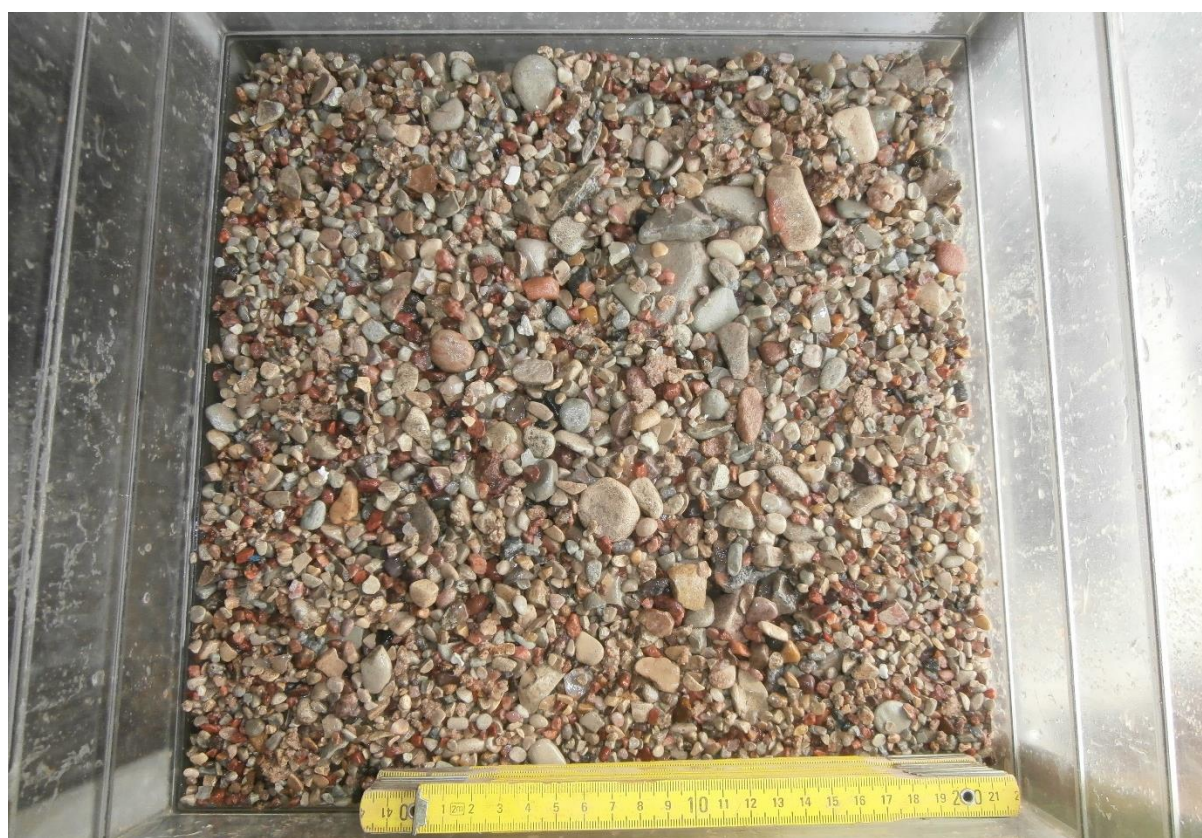
Joonis 23 Kruus märgsepareerimise seadmes pärast katse teostamist, kus on näha, et liiv on kruusafraktsioonist välja pestud
