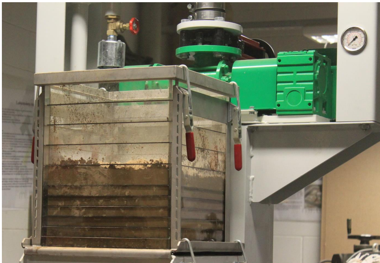
Joonis 4 Märgsepariirimsseade Alljig (foto: Mäeinstituut)
