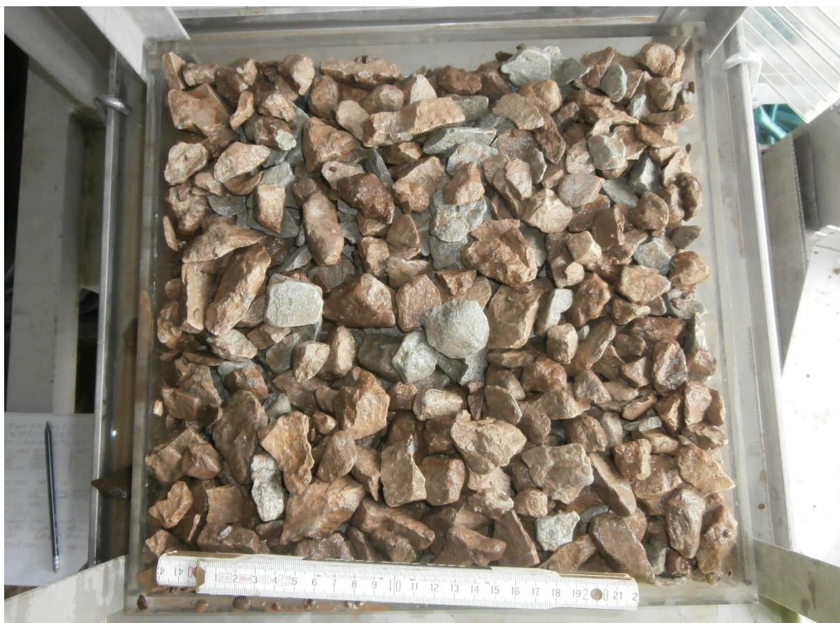
Joonis 10 Põlevkivi, sõelaavaga 16-31,5, märgsepareerimise seadme alumises kihis
