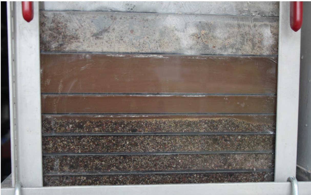
Joonis 19 Fosforiidist pestakse liiv välja
