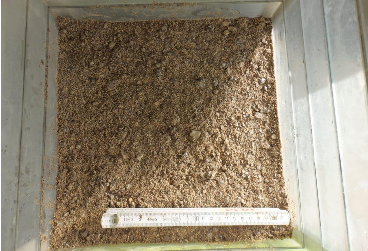
Joonis 18 Fosforiidi kaevis katse alguses
