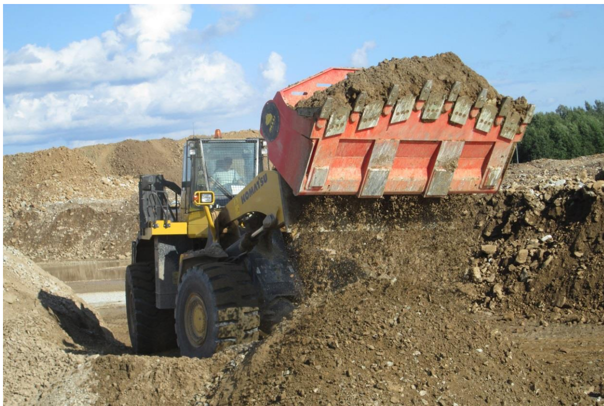
Joonis 2 Kuivrikastamine Allu purustuskopaga
