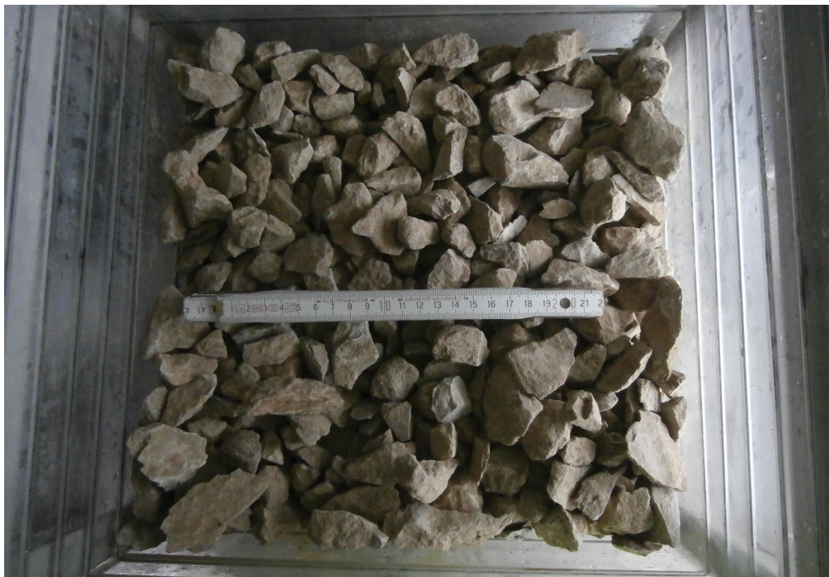
Joonis 8 Põlevkivi, sõelaavaga 16-31,5 mm, märgsepareerimise seadmes enne katse teostamist
