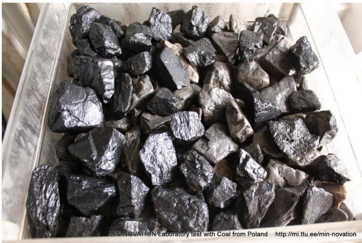
Joonis 28 Kivisöe märgsepareeritud klass. Läikivad mustad tükid on kivisüsi, halli varjundiga materjal on aheraine. Foto: Mäeinstituut
