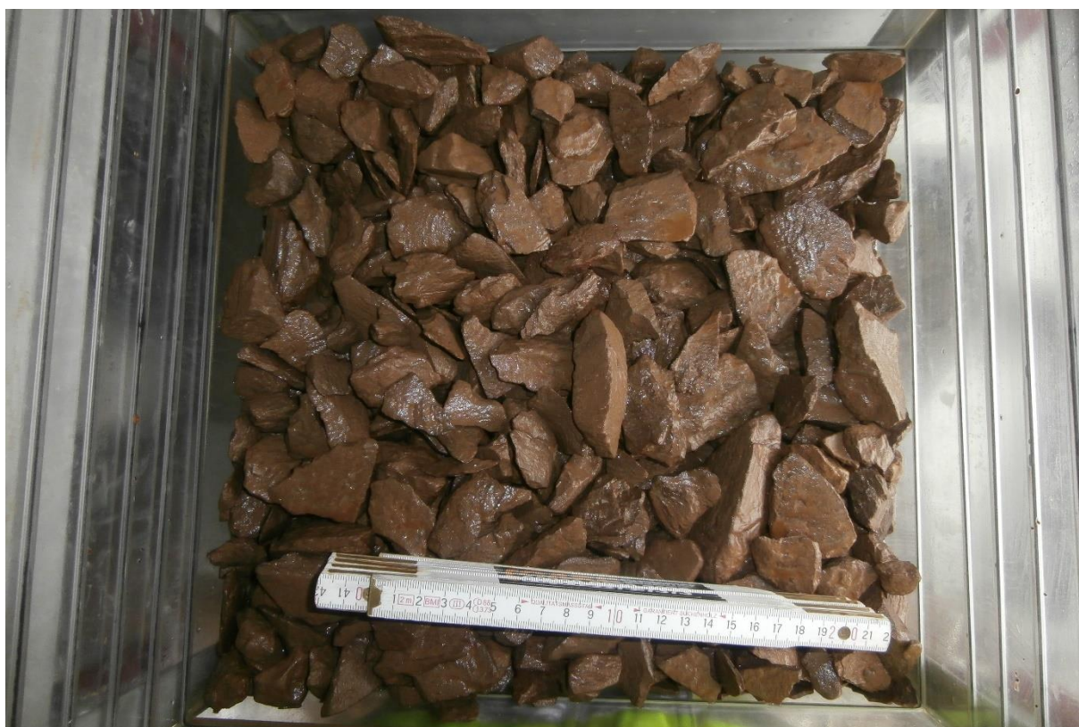
Joonis 9 Põlevkivi, sõelaavaga 16-31,5 mm, märgsepareerimise seadmes pärast katse teostamist
