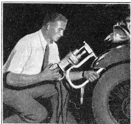
Elektri aparaat auto tüübade õiendamiseks. Elektri jõul töötav haamer teeb umb. 1000 lööki minutis, mis tööd märksa kiirendab.
