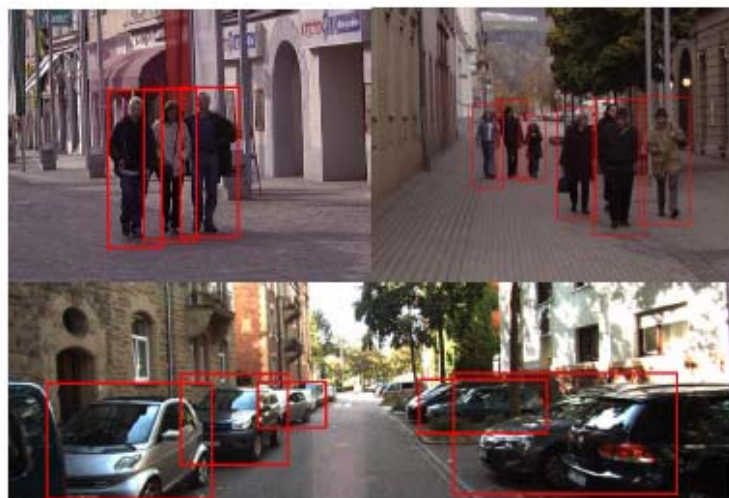
Sele 3.5 Näide masinnägemisest kasutades optilisi kaameraid [53]
