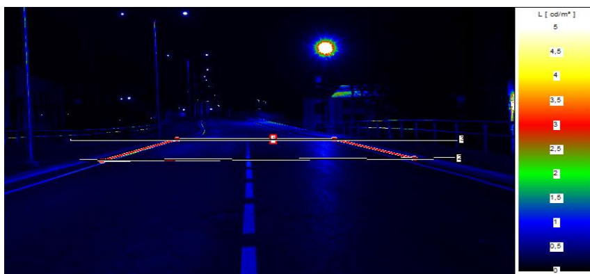
Joonis 2.3 2015. aastal tehtud mõõdistus, kontrollimaks prožektor mõju mõõtetulemustele
