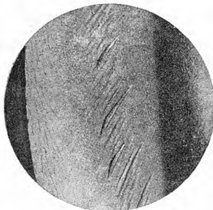
Rehvi sisepind juhul, kui sõitja on saanud liig tühjade rehvidega. Cord-kuded hakkavad üksteisest eralduma
