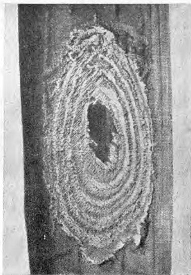
... ja seda võib juhtuda igal, kui pidurdamisel kiire sõidu juures ratas plökeerub
