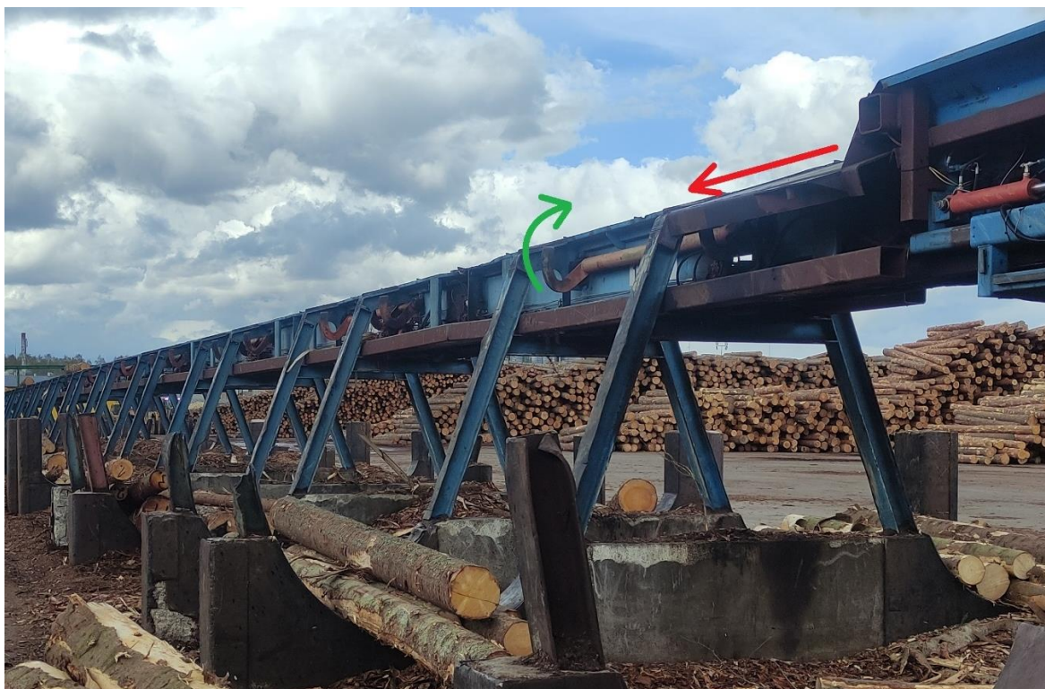
Joonis 3.1 Palgisorteereri sorteerimisliin, punase noolega on näidatud palkide liikumissuund liinil, rohelise noolega on näidatud käpa töösuund
