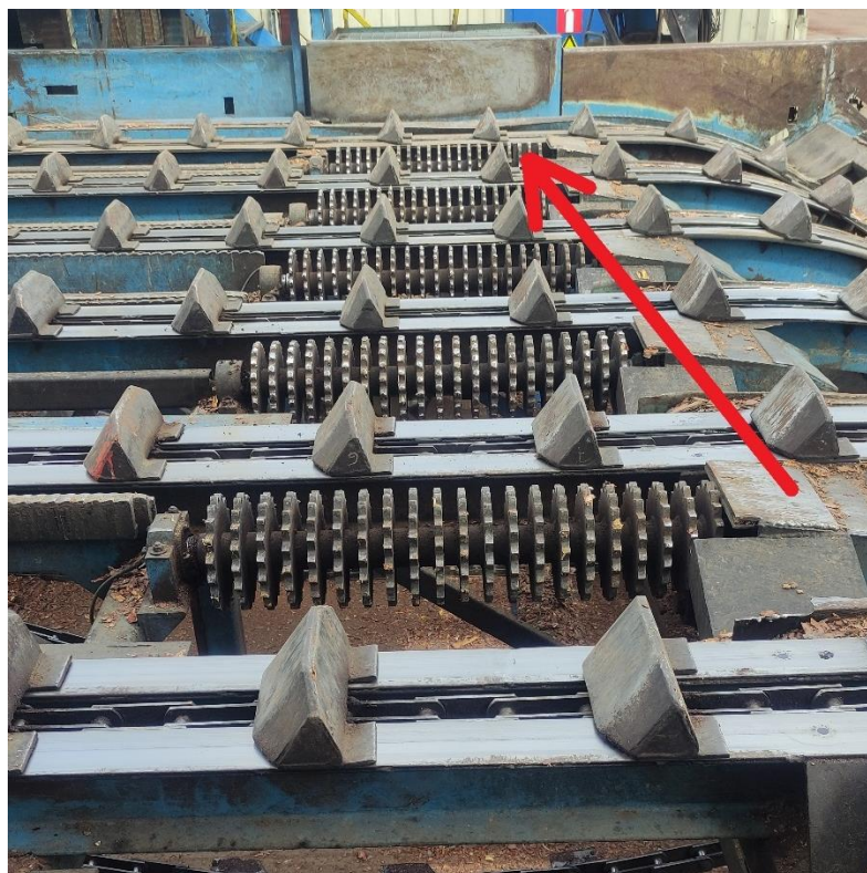
Joonis 2.3 Palkide üleveorullid, punase noolega näidatud palkide liikumise suund
