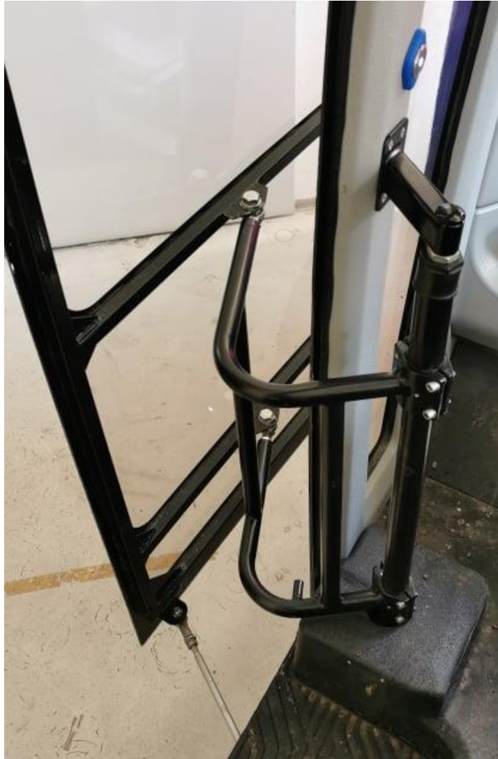
Joonis 2.3. Pöörleva postiga ukseüsteem iseAutos (Erakogu).
