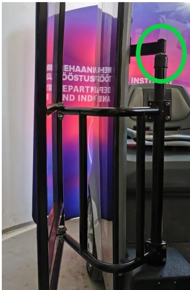
Joonis 1.2. Iseauto ukse süsteemi läbipaindunud detail (Erakogu).
