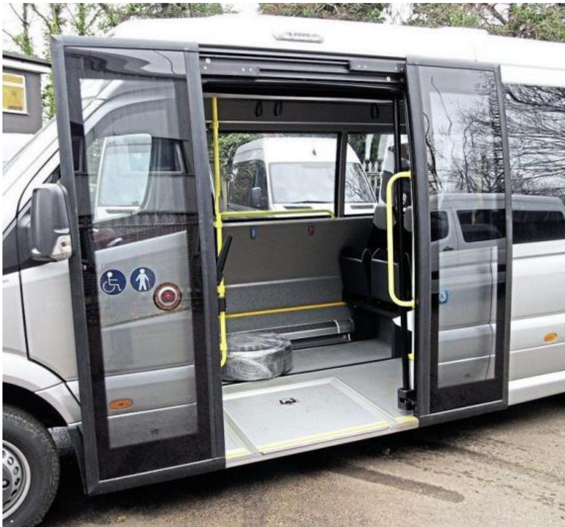
Joonis 3.1. Minibussi külge paigaldatud Masats 028a liuguks [14]
