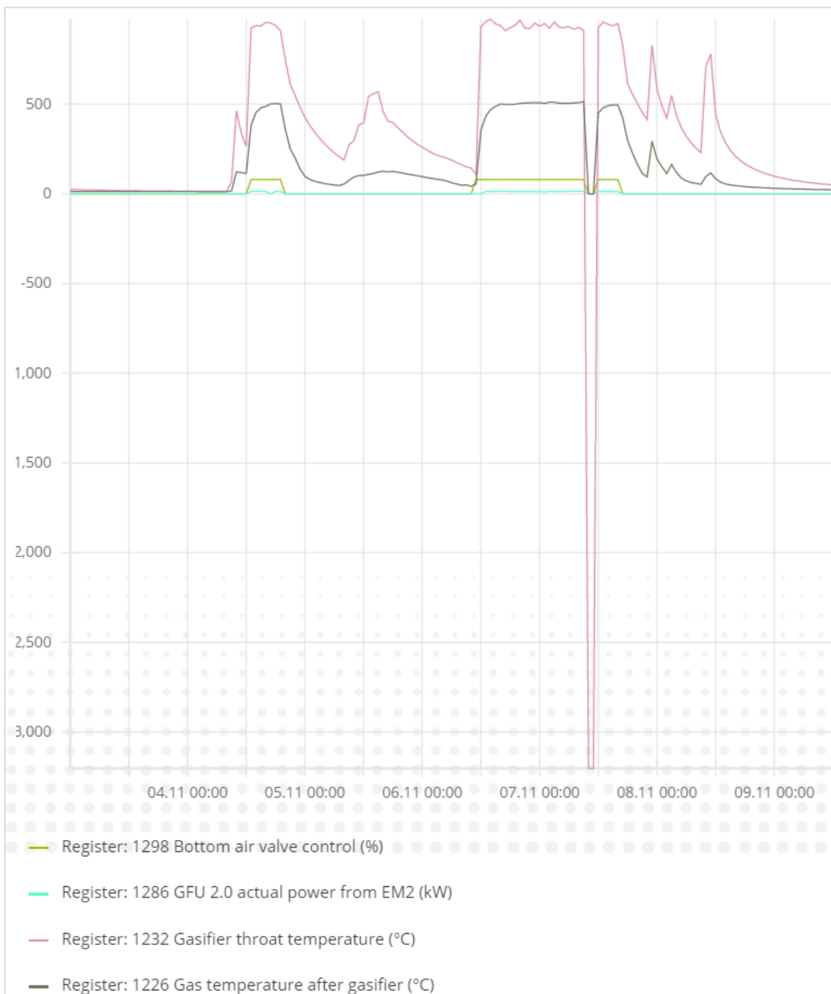
Joonis 4.6 Gaasisti lõõri temperatuur, gaasi temperatuur peale gaasistit, elektri tootmise võimsus ning õhu peaventiili asend
