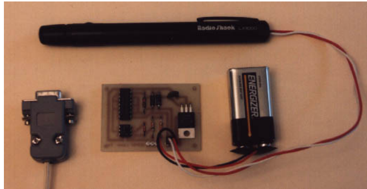
Joonis 5 Kahe arvuti ühendamiseks konstrueeritud saatja [18]
