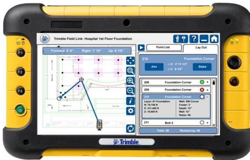
Joonis 15. Mobiilne seade, mis GPS abiga näitab rajatavate konstruktsioonide täpse asukoha. Allikas: Korec kodulehekül
